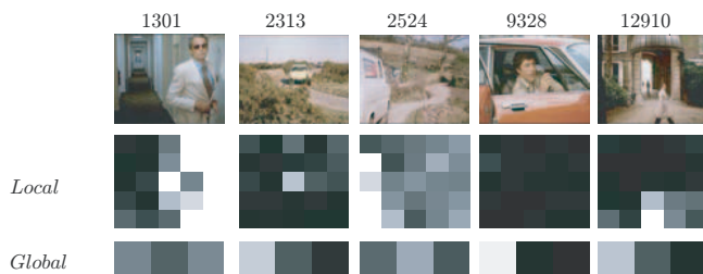
FIG. 3.11 – Exemple de descripteurs d'activité. En haut : Images de la séquence « The Avengers ». Au milieu : Descripteurs locaux d'activité. Le blanc correspond à une activité forte et le noir à une activité faible. En bas : Descripteurs globaux d'activité. Les cases de gauche, du centre et de droite représentent respectivement une activité faible, moyenne et élevée.
