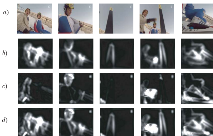
FIG. 7.12 – Exemple de cartes de saillance. a) images extraites de la vidéo « Documentaire », cartes de saillance : b) statiques, c) dynamiques, d) spatio-temporelles.
