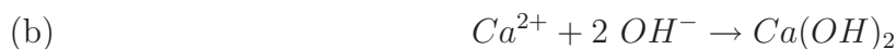
Equation 2 : Réactions de formation de l'hydrosilicate de calcium et de la portlandite
