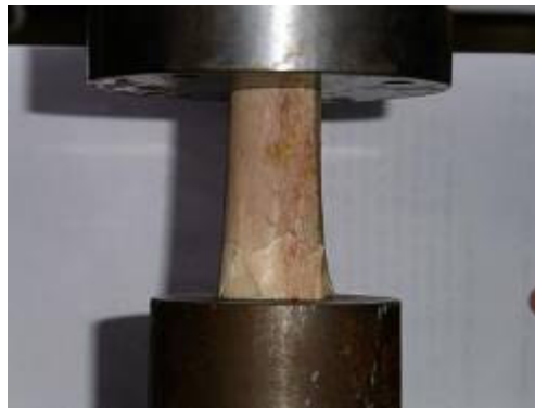
Figure 3.16 : Essai quasistatique en compression qui a mené l'échantillon de diaphyse fémorale humaine à rupture. On observe de la délamination sur le bas de l'échantillon.
