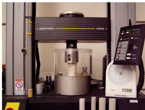
Figure 3.2 : Echantillon d'os bovin lors d'un essai de fatigue en compression dans la machine d'essai INSTRON 5569.
