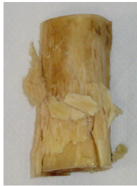
Figure 3.23 : Echantillon arrivé à rupture après 4 étapes d'endommagement.
