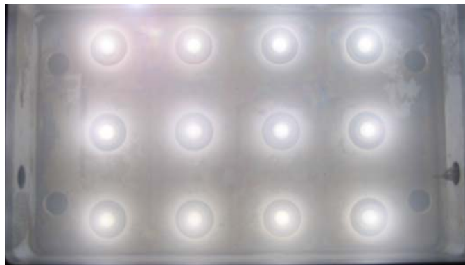
Figure 6.1. Vue de dessus d'un plasma d'oxygène ( P_w = 1950 W, p_{O_2} = 7 Pa).
