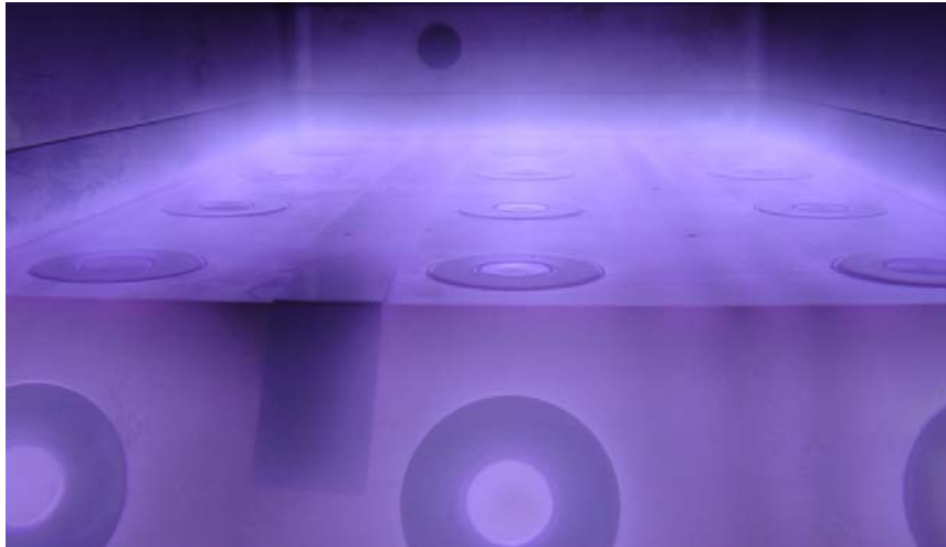
Figure 4.5. Vue de coté d'un plasma d'argon ( p_{Ar} = 100 \text{ Pa} , P_w = 1000 \text{ W} ).
