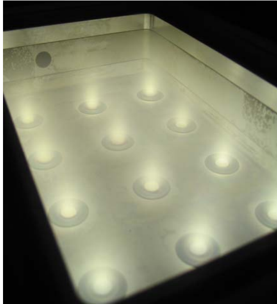
Figure 6.2. Vue panoramique d'un plasma d'oxygène ( P_w = 1200 W, p_{O_2} = 19 Pa).
