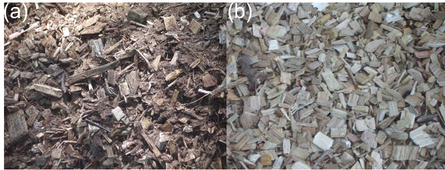
FIG. 3.14 – Les deux types de combustibles testés. (a) granulés de bois non homogènes et humides, (b) granulés de bois homogènes et secs.
