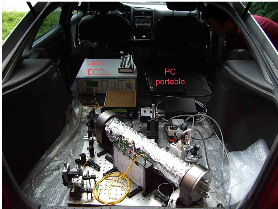
FIG. 3.16 – Le spectromètre de terrain installé dans le coffre d'une automobile.
