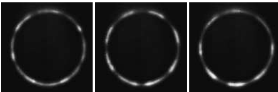
FIG. 5.9 – Fronts réactifs en vue arrière axiale, séquence de 3 images espacées de 14,3 \mu\text{s} – Tir 92 : \delta=3,5 mm, débit 30–35 g/s, richesse 0,8–1,2 – Caméra Photron APX RS3000, lumière directe, temps d’exposition 2 \mu\text{s} , cadence 70 000 images/seconde, objectif 17 mm, 128 \times 128 pixels
