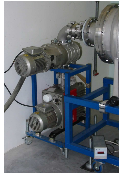
FIG. 3.22 – Groupe de pompage BOC Edwards
