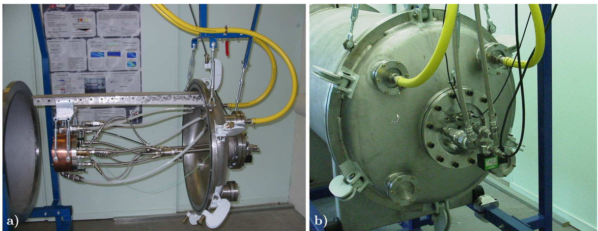
FIG. 3.20 – a) Potence de suspension du moteur - b) Couvercle de l'enceinte
