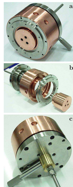
FIG. 3.3 – Moteur en vue éclatée (b) et vues assemblées (a, c)
