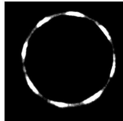
FIG. 5.6 – 8 fronts réactifs en vue arrière axiale – Tir 142 : \delta=3,5 mm, débit 30–35 g/s, richesse 0,9–1,2 – Caméra Hamamatsu , lumière directe, temps d'exposition 100 ns, intensification 80%, gain caméra 170, 1024 \times 1024 pixels
