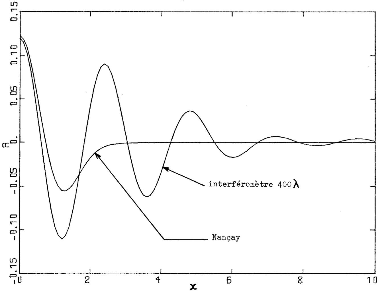
Figure II.3 Réponses de la méthode utilisée à Nançay et d'un interféromètre type à un nuage de distribution de brillance gaussienne de diamètre 8', décalé de  $x$  (l'unité est de 4') en ascension droite par rapport à la source étudiée (comparer avec la figure IV.5).
