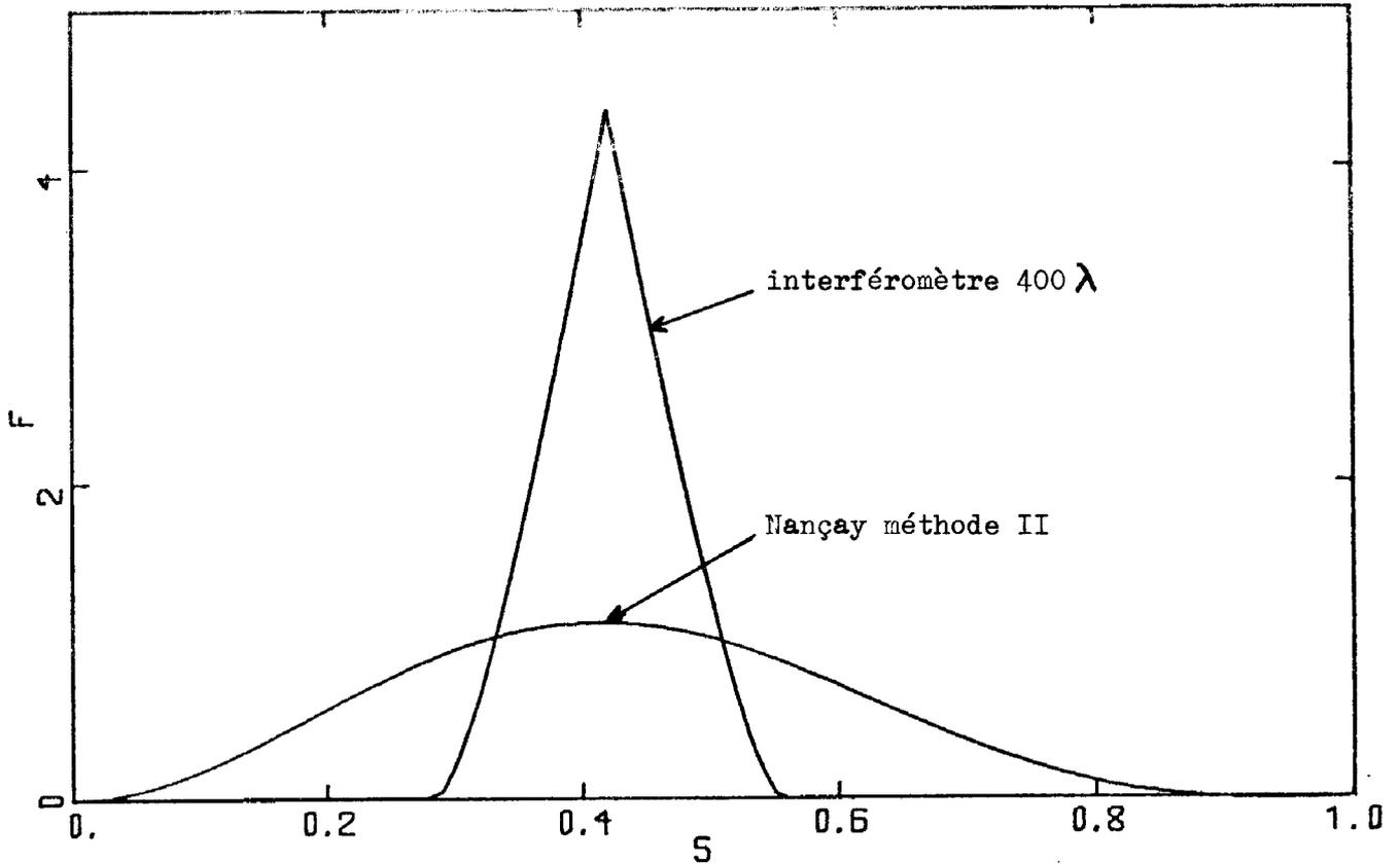
Figure II.2 Comparaison, dans l'espace des fréquences spatiales, du gain de la méthode utilisée à Nançay avec celui d'un interféromètre type.
