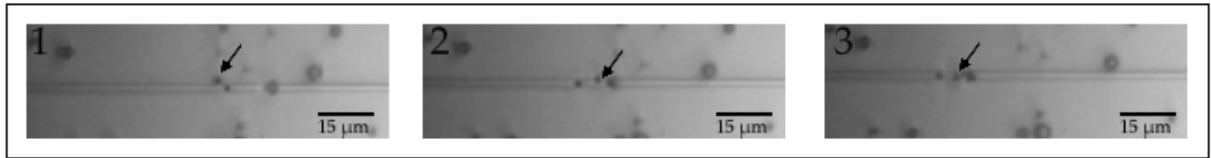
FIG. 3.13 – Illustration de l’existence de forces de gradient pour un guide de nitrure de silicium et des particules de verre. Les forces de gradient générées avec les guides en nitrure de silicium permettent aux billes de verre (flèche noire) de grimper la marche de 200 nm formant la zone guidante.
