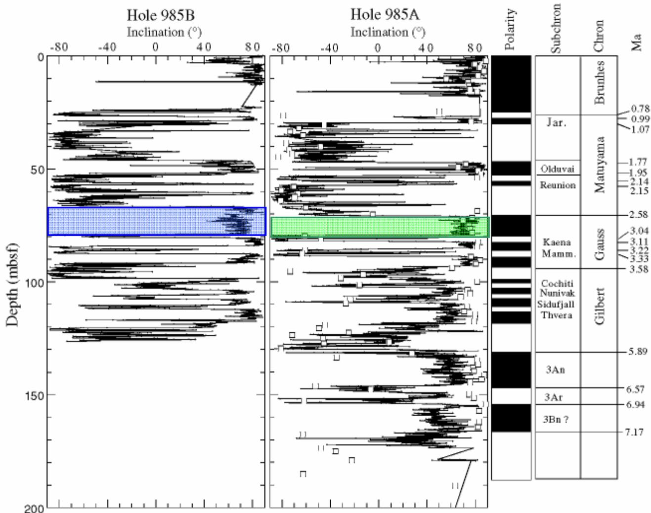
**Fig. 37: Variations de la polarité magnétique en fonction de la profondeur (mbsf) dans les trous A et B permettant d'identifier une zone de pertes importantes correspondant à la zone de non-corrélation (Fig. 37)**
