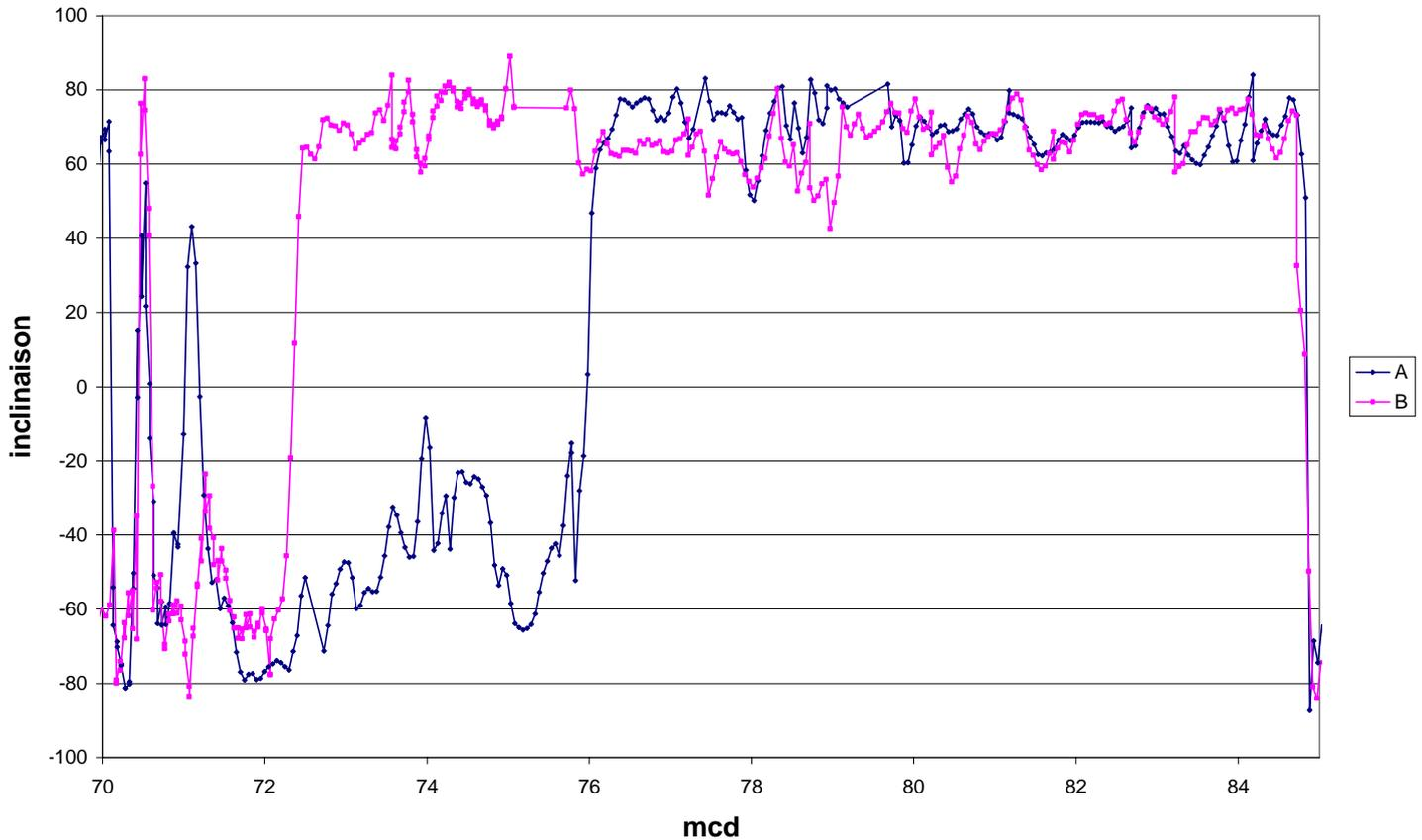
**Fig. 38: Données de l'inclinaison en fonction de la profondeur composite**
