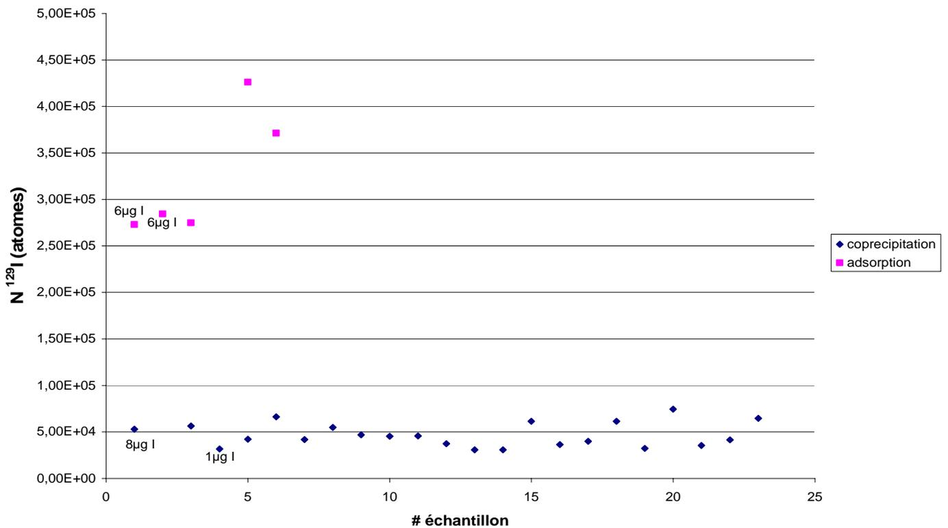
**Fig. 20: Comparaison de la contamination en <sup>129</sup>I induite par adsorption ou coprécipitation à partir de 10 µg d'I (sauf indication contraire)**
