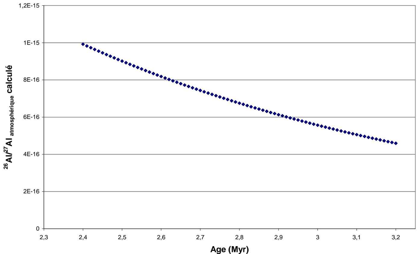
**Fig. 32: Bruit de fond atmosphérique théorique en  $^{26}\text{Al}$  calculé sur 2.4-3.2 Myr à partir de la mesure du rapport  $^{26}\text{Al}/^{27}\text{Al}$  au sommet de la carotte**
