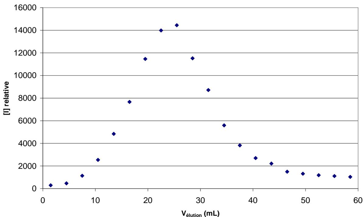
**Fig. 17: Détermination du volume d'élution de  $\text{KNO}_3$  nécessaire pour séparer l'iode sur AG1X8. L'ordonnée est exprimée comme une concentration relative en iode (signal icp-ms en cps), les effets de matrice du milieu ( $\text{KNO}_3$ ) n'ayant pas été évalués par la méthode des ajouts**
