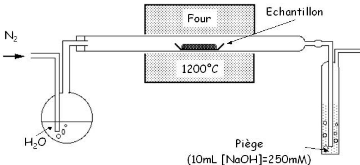
**Fig. 16: Dispositif de pyrohydrolyse**
