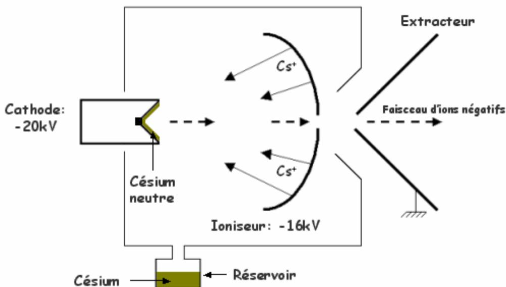
**Fig. 12: Schéma de la source du Tandétron**
