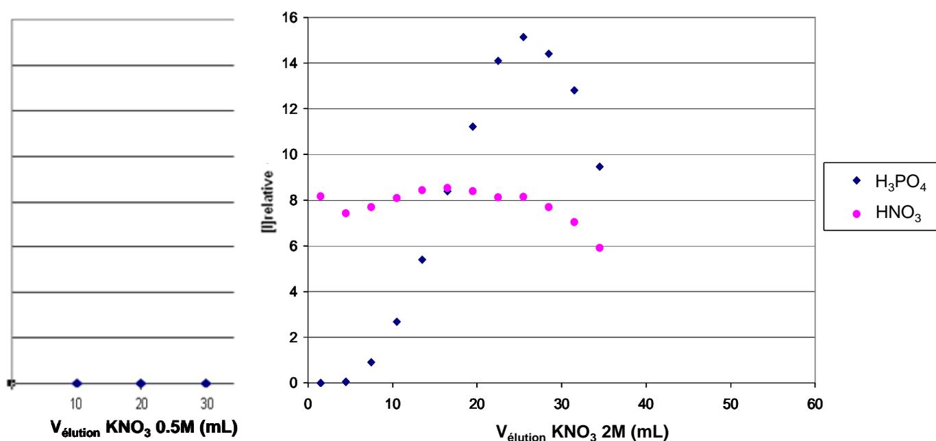
**Fig. 18: Comparaison des profils d'élution avec  $KNO_3$  2M après acidification avec  $HNO_3$  ou  $H_3PO_4$ . L'ordonnée est exprimée comme une concentration relative, les effets de matrice potentiels du milieu n'ayant pas été évalués par la méthode des ajouts**
