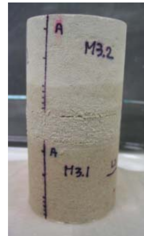
Figure VI.12 : Test d'imbibition pour la pierre jointe par les mortiers durcis
