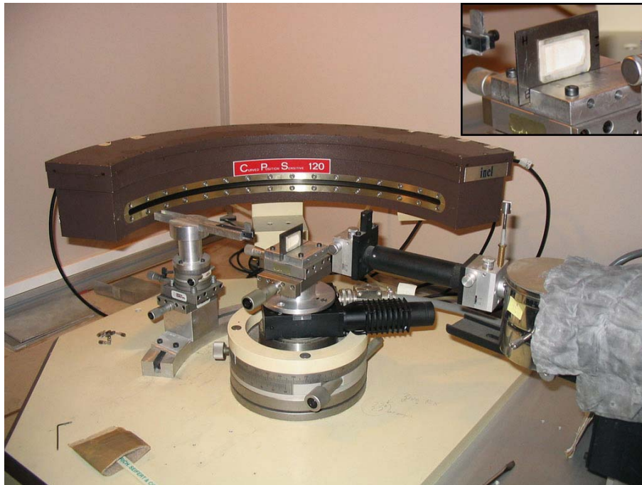
Figure I.50 : montage expérimental de diffraction des rayons X en transmission appliqué à l'étude d'échantillons massifs (en détail : le porte-échantillon)
