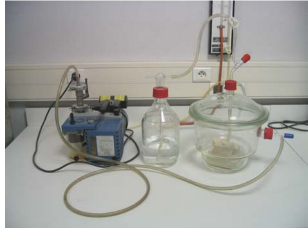
Figure II.11 : photographie et schéma explicatif du montage de mesure de la porosité à l'eau
