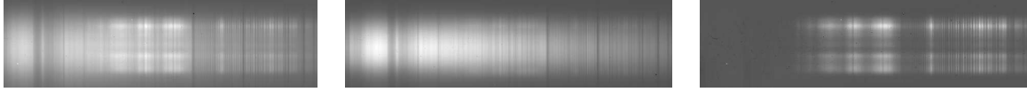
FIG. 5.2 – À gauche : image spectrale brute (côté nuit) ; au centre : image spectrale brute (côté jour) ; à droite : image spectrale de la composante thermique. Les abscisses correspondent à la dimension de dispersion spectrale en longueur d’onde, l’ordonnée représentant la dimension spatiale non dispersée le long de la fente (latitude sur Vénus).
