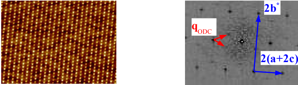
Fig 4.23: Image STM (données brutes) haute résolution à courant constant avec résolution moléculaire de 20 \times 25 \text{ nm}^2 de la surface (\bar{2}01) de \text{Rb}_{0.3}\text{MoO}_3 dans la phase ODC à T=63\text{K} montrant les occupés de l'échantillon ( V_{\text{bias}}=-500\text{mV} , à gauche). La transformée de Fourier 2D associée montre que le vecteur d'onde de l'ODC possède une composante q_b=0.22 , différente de la valeur 0.25 de volume.
