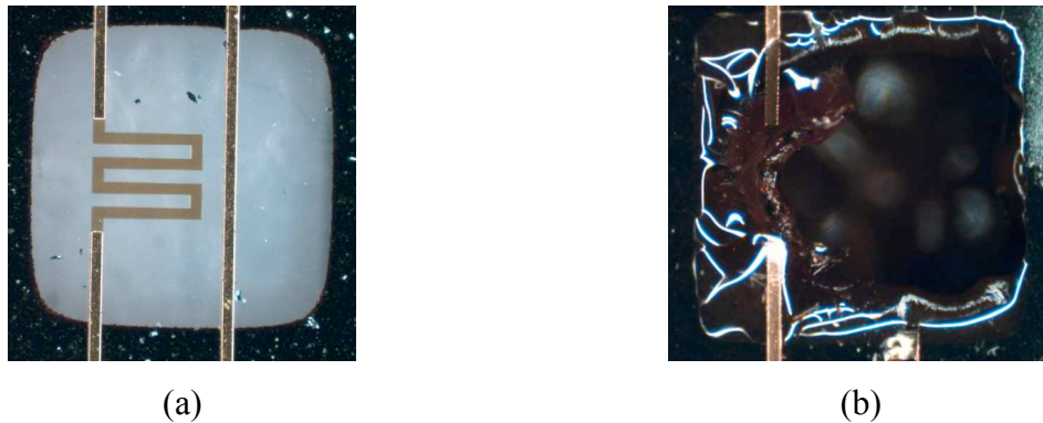
Figure 65. Interrupteur ON-OFF pyrotechnique avant (a) et après (b) commutation.
