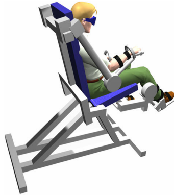
Figure 34 : Dispositif expérimental utilisé pour l'étude des coordinations entre le poignet et la cheville
