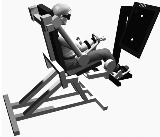
Figure 76 : Représentation du dispositif expérimental utilisé dans la tâche de coordination entre le poignet et la cheville au cours de laquelle les informations visuelles étaient manipulées.
