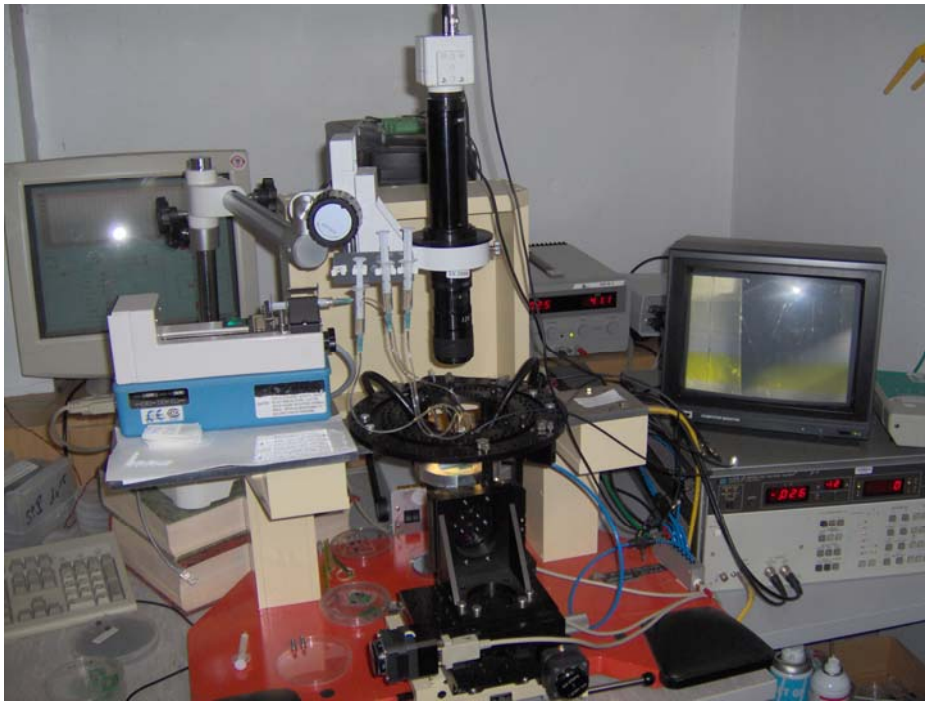
Figure 2.61 : photo du banc de mesure sous pointe
