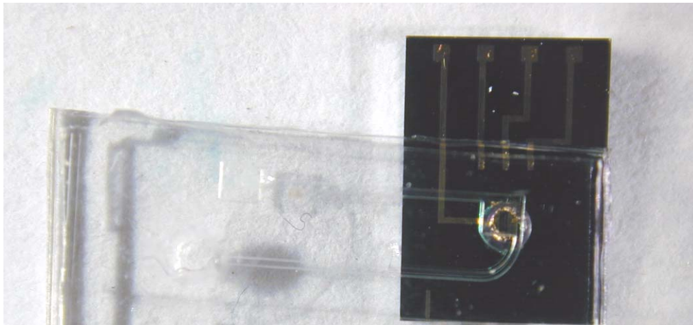
Figure 2.39 : microcuve avec microcanaux reporté sur un composant
