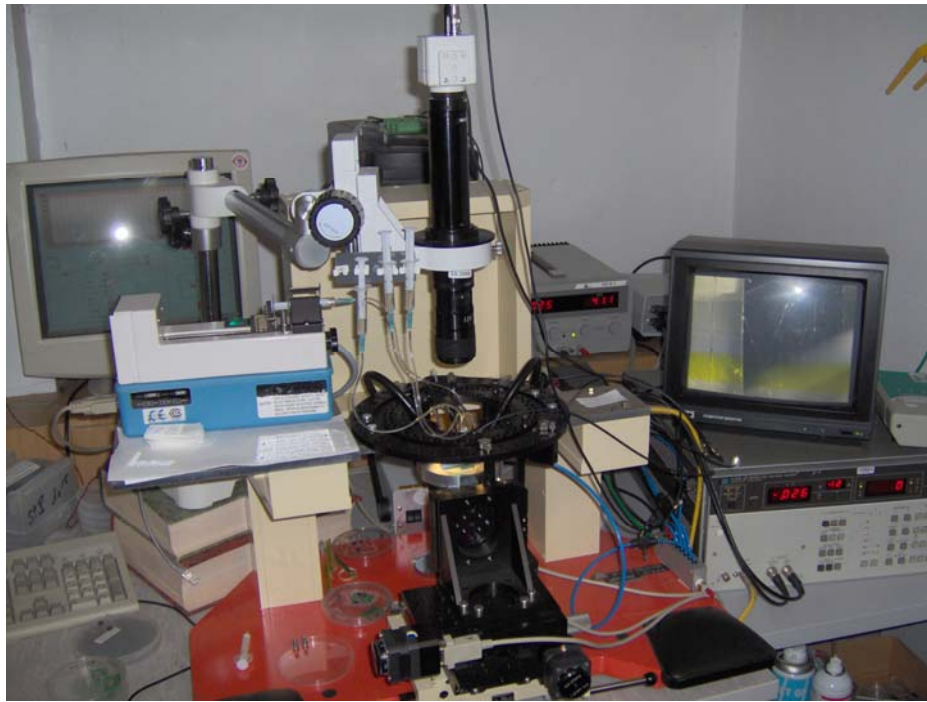
Figure 2.61 : photo du banc de mesure sous pointe
