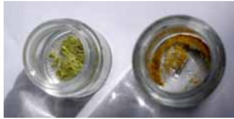
**Figure IV-3: Photographie illustrant l'effet thermochrome observé pour  $x = 0,15$ .**
