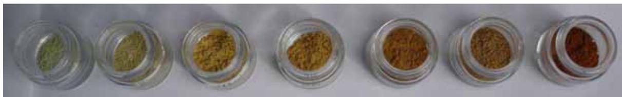
**Figure III-8: Photographie de quelques compositions  $\text{Zn}_{1-x}\text{Cu}_x\text{Al}_2\text{O}_4$  obtenues par la voie d'estérification (de gauche à droite dans l'ordre  $x = 0,15$ ,  $x = 0,20$ ,  $x = 0,30$ ,  $x = 0,40$ ,  $x = 0,50$ ,  $x = 0,60$ ,  $x = 1,00$ )**
