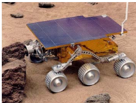
FIG. 1.2 – Robot mobile "Sojourner" utilisé pour la mission Pathfinder de la NASA
