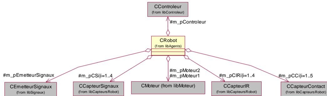
FIG. 7.5 – Schéma UML de l'organisation des classes d'un mini-robot ALICE simulé
