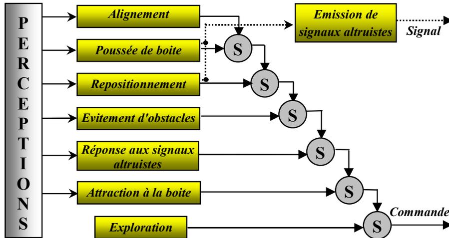
FIG. 4.11 – Architecture de contrôle à base de PSAH appliquée à la tâche coopérative de poussée d’objets “TCPO”.
