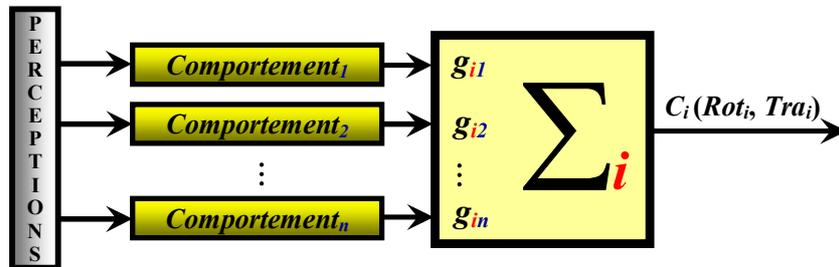
FIG. 5.1 – Bloc de fusion de commandes
