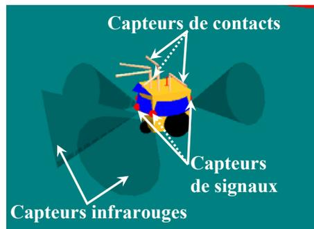
FIG. 7.6 – Capteurs simulés du mini-robot ALICE
