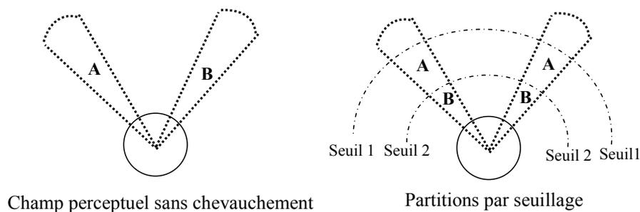
FIG. 3.6 – Capteurs spatialement orthogonaux (Kube & Zhang 1997)
