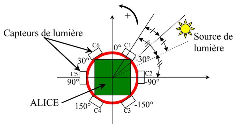
FIG. 8.5 – Anneau de six capteurs de lumière
