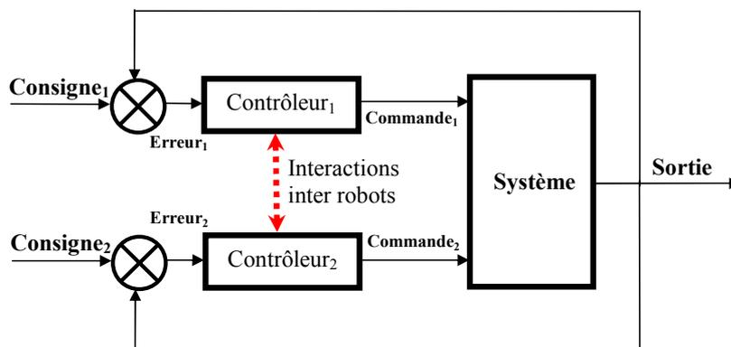
FIG. 1.5 – Schéma d'asservissement d'un système multi-robots
