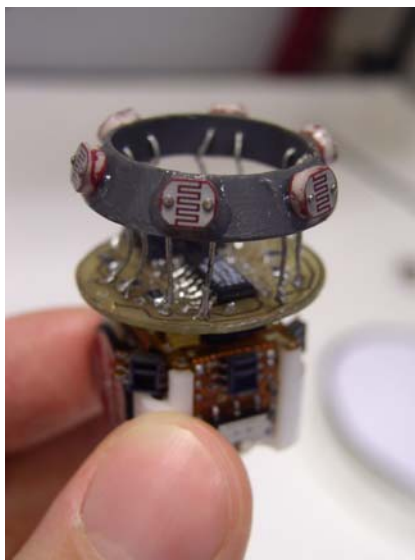
FIG. 8.8 – Étage capteurs ajouté à ALICE
