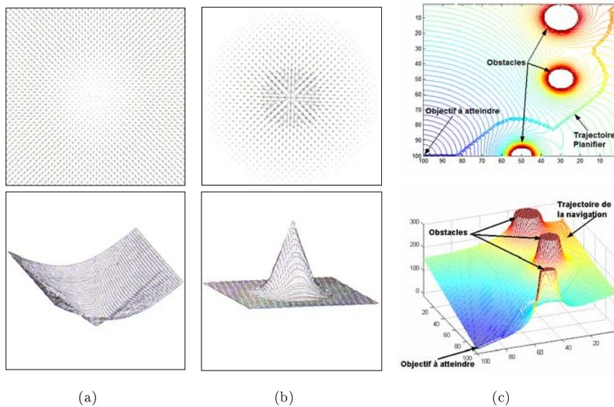
FIG. 3.11 – Les figures (a) et (b) représentent respectivement les champs de forces 2D et 3D, générés par les schémas moteurs : *aller-vers-l'objectif* et *éviter-un-obstacle-statique*. La figure (c) correspond à l'addition de schémas moteurs pour la navigation (atteindre l'objectif tout en évitant les obstacles) d'un robot mobile.
