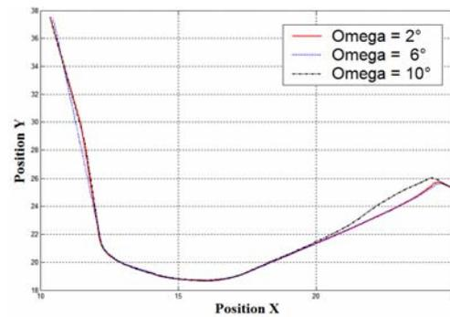
(d) Trajectoires du robot pour différents  $\Omega$
