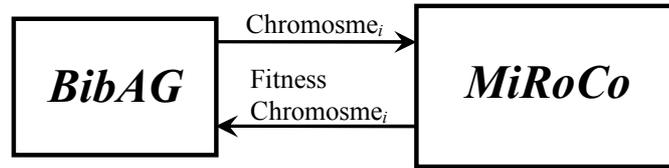
FIG. 6.10 – Interface existante entre la bibliothèque pour algorithmes génétiques “*BibAG*” et le simulateur “*MiRoCo*”.
