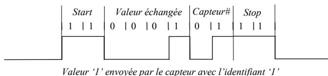
FIG. 8.13 – Type d'informations transmises entre robots
