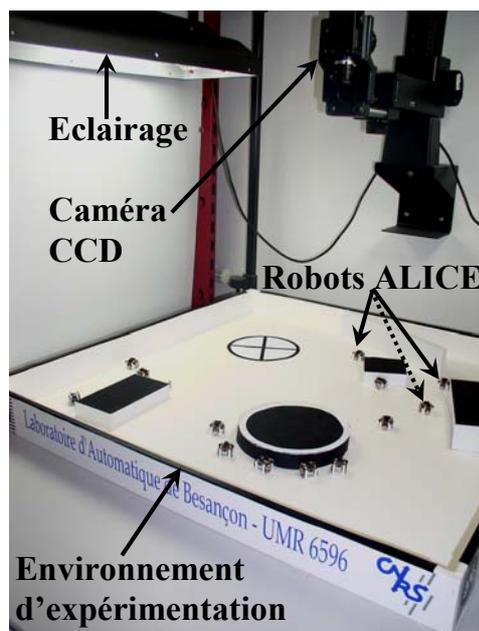
FIG. 8.1 – Plate-forme expérimentale
