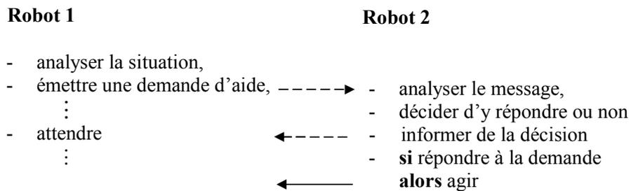
FIG. 1.9 – Scénario possible d'une communication de haut niveau
