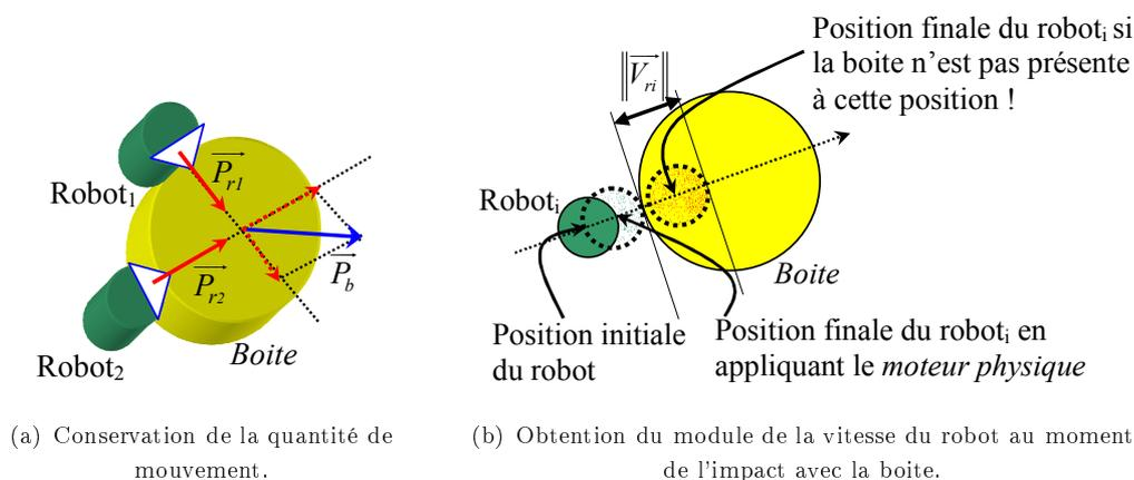
FIG. 7.10 – Modèle de déplacement de la boîte
