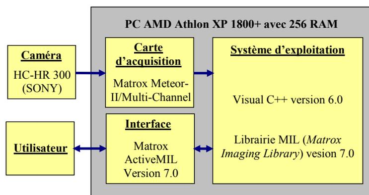
FIG. 8.2 – Chaîne d'acquisition et de traitement vidéo utilisée
