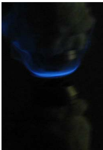
FIG. 6.1 – Position de la flamme dans l'espace interbuses en fonctionnement.
