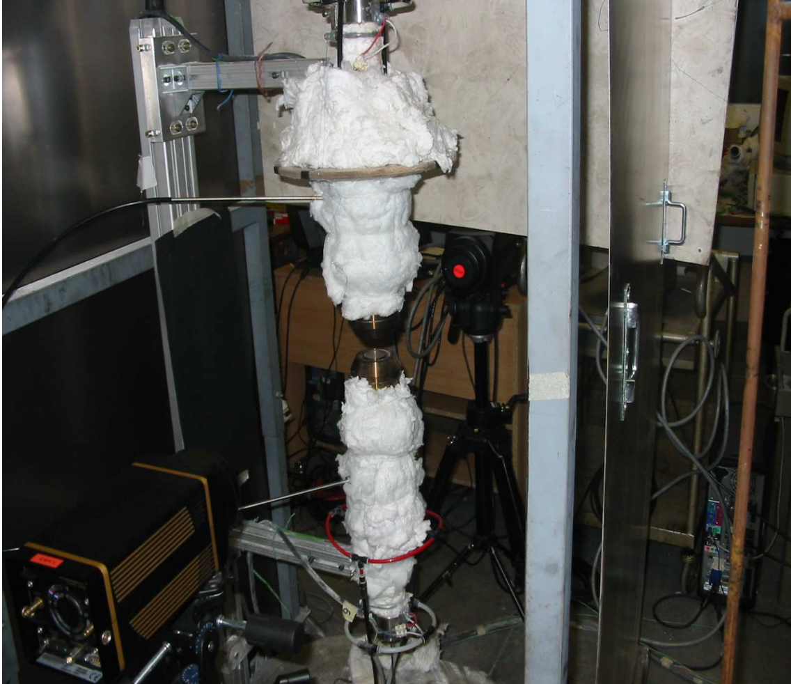
FIG. 2.11 – Vue d'ensemble du montage Parasol A1 KWS2P3 sur son banc de mesure. Autour, on distingue de l'instrumentation pour des mesures avec des caméras intensifiées. La matière blanche est du Kerlane, un ignifuge isolant très puissant.
