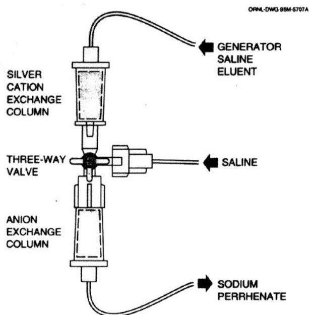
**Le système de concentration (colonnes échangeuses d'ions)**
