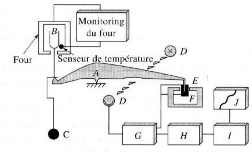
**Figure 32** : Composantes d'une thermobalance : A, fléau ; B, coupelle portant l'échantillon ; C, contrepoids ; D, lampe et photodiodes ; E, bobine ; F, aimant ; G, amplificateur de contrôle ; H, système de contrôle de la tare ; I, amplificateur ; J, enregistreur. (Document de Mettler Instrument Corp., Highstown, USA)
