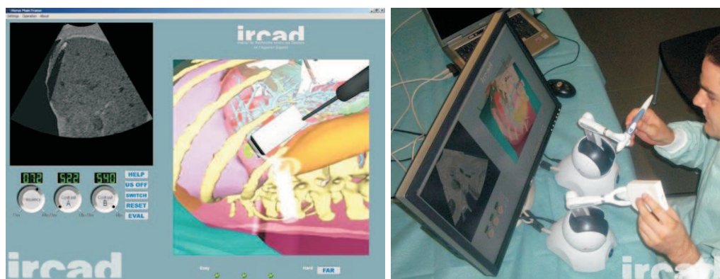
FIG. 1.3 – Simulateur pour la formation des médecins aux gestes inhérents aux échographies tels que l'insertion d'aiguilles (IRCAD - Projet HORUS)
