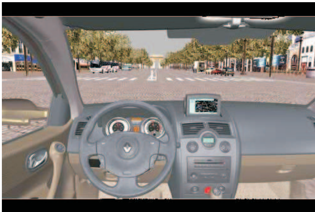
FIG. 1.2 – Simulateur de conduite présentant l'ensemble du tableau de bord (RENAULT)
