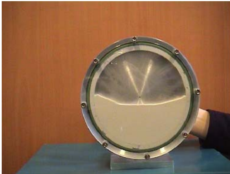
Figure 26 : Système permettant de mesurer les angles critique et sous-critique à l'air et sous vide. a) Image 3D réalisée sous CATIA – b) Photo du système contenant la poudre de microbilles.
