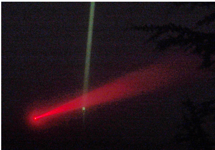
FIG. 4.34 – Image des faisceaux lumineux du transmissomètre (vert) et du laser à 650 nm (rouge) prise de nuit en présence de brouillard dense.
