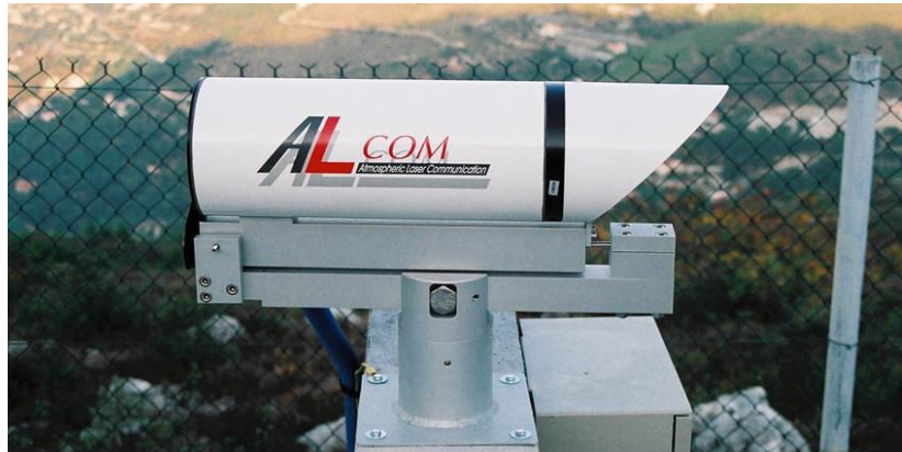
FIG. 4.13 – Unité FSO ALcom de la société Actipole (émission-réception) déployé sur le site de La Turbie.
