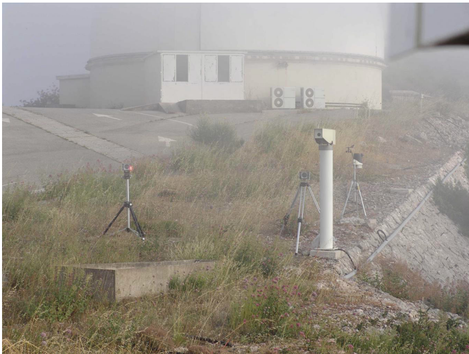
FIG. 4.33 – Configuration du second déploiement photographié à partir des détecteurs (on note le spot rouge sur l'émetteur à 650 nm).
