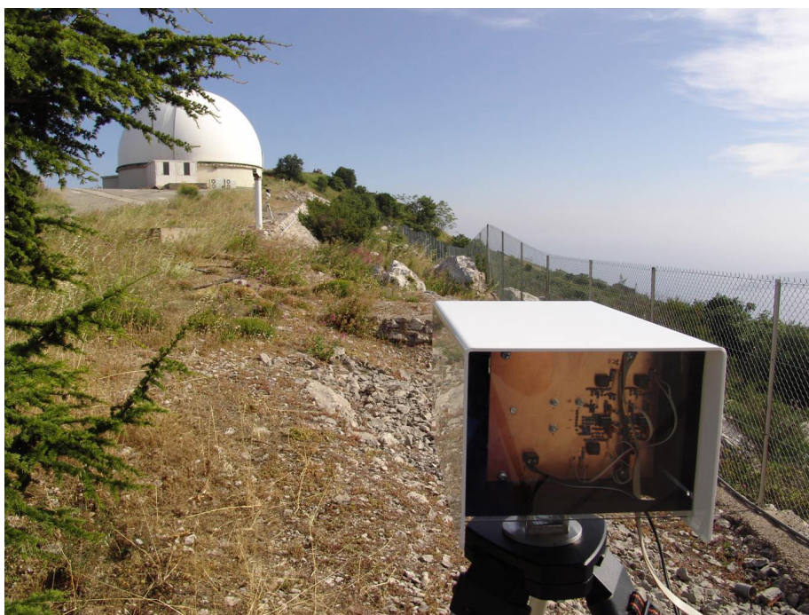
(a) Détecteur à 850 et 950 nm monté sur un trépied et placé en face de l'émetteur.
