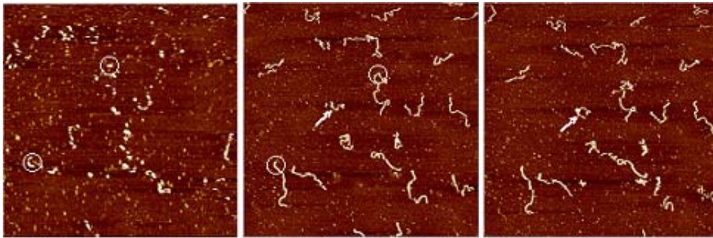
Figure II-11 : Modulation de l'adsorption sur mica prétraité nickel. Gauche : Tris 10 mM pH 7,5 NaCl 200 mM ; centre et droite : Tris 10 mM pH 7,5 MgCl 2 5 mM. Sur mica prétraité nickel, même à concentration élevée en sel monovalent les molécules d'ADN ne quittent pas la surface. Il est possible d'alterner réversiblement entre des conditions où l'ADN est peu adsorbé (et très disponible pour interagir avec des ligands) et des conditions où l'ADN est fortement adsorbé (et moins disponible pour interagir avec des ligands). Même quand l'ADN est fortement adsorbé, il reste mobile sur la surface.
