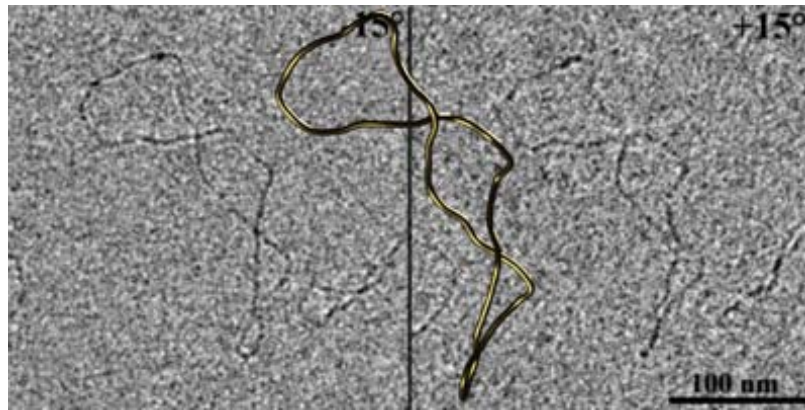
Figure II-3 : Observation d'ADN circulaire piégé dans la glace vitreuse en cryomicroscopie électronique à transmission. A partir de deux images stéréoscopiques (-15 et +15°) la trajectoire tridimensionnelle de la molécule d'ADN peut être reconstruite.
