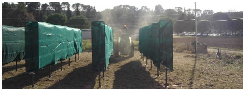
FIG. 3.6 – Disposition du système de simulation de la végétation pendant une application expérimentale
