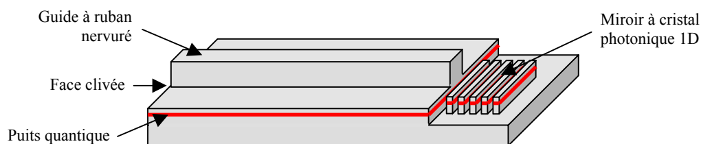
Fig.8 : Diode laser à ruban nervuré utilisant un miroir à cristal photonique 1D.
