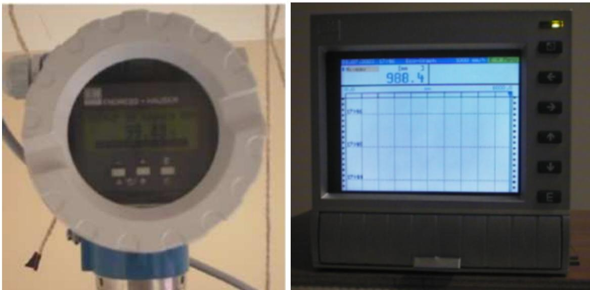
FIG. 7.1 – *Le Levelflex et l'échographe*
