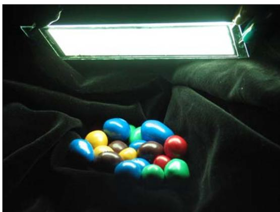
**Figure I- 11** Panneau d'éclairage de 35 cm<sup>2</sup> utilisant un polymère émettant dans le blanc (Source : Siemens)
