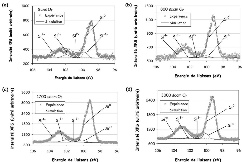
**Figure A.VIII 2:** Spectres de niveau de Coeur du Si 2p pour un angle d'incidence de 35°. (a) pour un dépôt sans flux d'oxygène, (b) pour un flux de 800 sccm d'oxygène, (c) pour 1700 sccm d'oxygène et (d) pour 3000 sccm d'oxygène.
