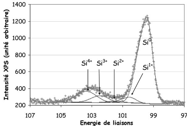
**Figure II 12:** Spectre de niveau de cœur du silicium, Si 2p, mesuré par AR-XPS à 75° pour un film de 2,7 nm de HfO<sub>2</sub> déposé à 550°C.
