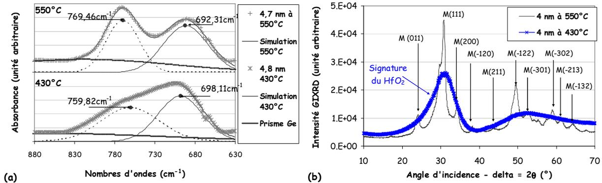
**Figure IV 8:** (a) Spectres ATR des échantillons de 4,7 nm déposés à 550°C et 4,8 nm déposés à 430°C. Les bandes du spectre d'absorptions ont été décorrélés dans la gamme de longueur d'ondes caractéristique du matériau HfO<sub>2</sub>. (b) Spectre GIXRD pour des films de HfO<sub>2</sub> de 4,6 nm déposés à 550°C et 5 nm déposés à 430°C.
