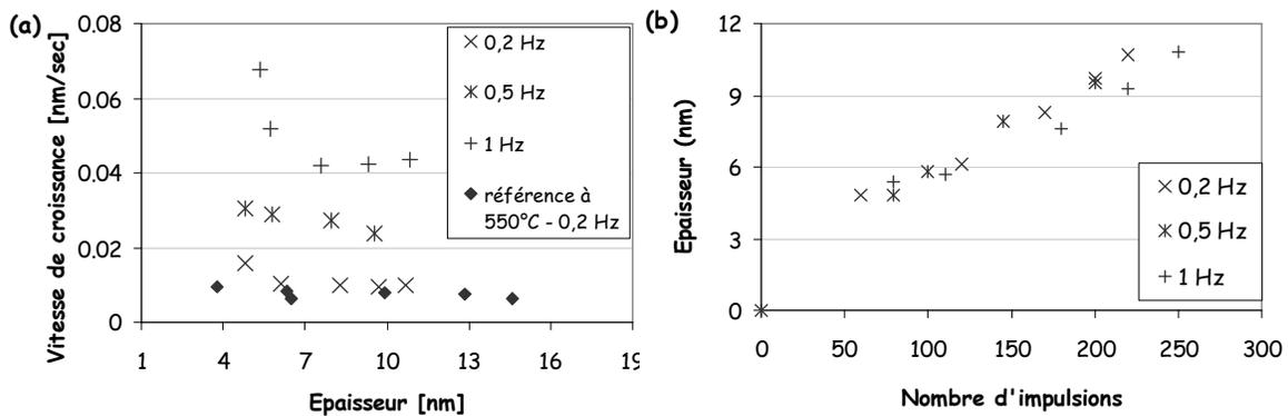
**Figure III 1:** (a) Vitesse de croissance du  $\text{HfO}_2$  en fonction du nombre d'impulsions, pour des films déposés à  $430^\circ\text{C}$ . Les fréquences d'injection, à 0,2, 0,5 et 1 Hz sont comparées. La vitesse de croissance à  $550^\circ\text{C}$ , à une fréquence de 0,2 Hz est tracée comme référence. (b) Epaisseurs mesurées à  $430^\circ\text{C}$ , en fonction du nombre d'impulsions, pour les trois fréquences testées.
