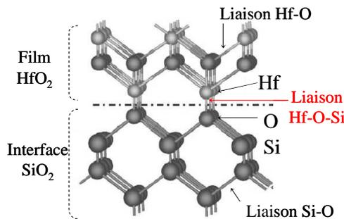
**Figure II 17:** Schéma représentatif de la création d'interface entre HfO<sub>2</sub> et SiO<sub>2</sub> lors de la croissance du HfO<sub>2</sub>. Cette interface génère la présence de liaisons Hf-O-Si provenant du contact entre les deux matériaux.
