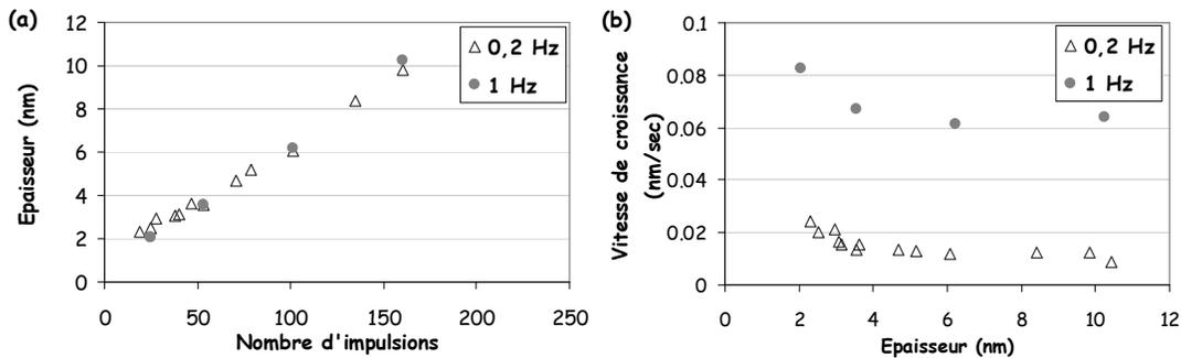
**Figure II 2:** (a) Epaisseur des films de HfO<sub>2</sub> en fonction du nombre d'impulsions, pour une fréquence d'injection de précurseur de 1 Hz et 0,2 Hz. (b) Vitesse de croissance instantanée en fonction de l'épaisseur, pour les deux fréquences d'injection.
