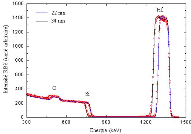
**Figure II 19:** Spectres RBS en fonction de l'énergie pour des échantillons de 22 et 34 nm de HfO<sub>2</sub> déposés à 550°C.
