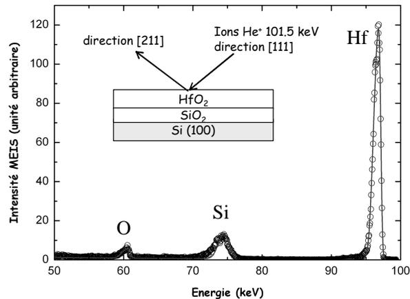
**Figure II 13:** Spectre MEIS expérimental de l'empilement HfO<sub>2</sub>/SiO<sub>2</sub>/Si(100) déposé à 550°C. Le schéma inséré illustre la configuration utilisée : un faisceau d'ions incidents He<sup>+</sup>, d'une énergie de 101,5 keV, est aligné le long de l'axe [111] du substrat de silicium. La fraction des ions diffusés dans la direction [211] est observée.
