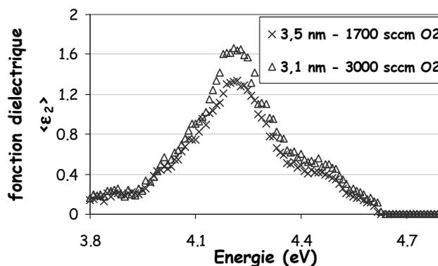
**Figure III 14:** Partie imaginaire de la pseudo fonction diélectrique  $\langle \epsilon_2 \rangle$  en fonction de l'énergie des photons, après l'utilisation de la méthode d'inversion point par point. La présence de lacunes dans des films de 3 nm de  $\text{HfO}_2$  est identifiée en fonction du flux d'oxygène.
