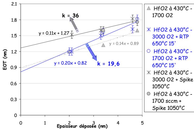
**Figure IV 19:** EOT en fonction de l'épaisseur de HfO<sub>2</sub> déposé à 430°C. L'effet des traitements thermiques (recuit 650°C, 15' (pour 15 min) sous N<sub>2</sub> et « spike » 1050°C) est examiné.
