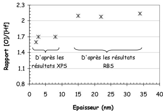
**Figure II 20:** Evolution du rapport [O]/[Hf] en fonction de l'épaisseur de HfO<sub>2</sub> déposé à 550°C. Les mesures ont été obtenues grâce aux techniques de caractérisation AR-XPS et RBS<sup>‡</sup>.
