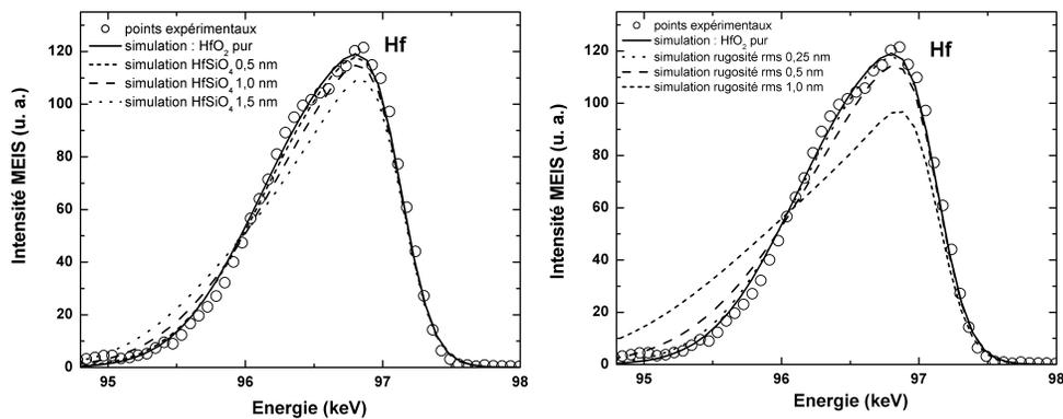
**Figure A.IX 2:** Spectres MEIS de l'oxyde d'hafnium déposé à 430°C. (a) Le profil est simulé avec la présence de différentes épaisseurs de silicate à l'interface HfO<sub>2</sub>/SiO<sub>2</sub>. (b) Le profil est modélisé avec la présence de différentes rugosités RMS à l'interface.
