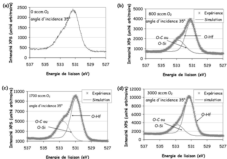
**Figure A.VIII 3:** Spectres de niveau de Coeur du O 1s pour un angle d'incidence de 35°. (a) pour un dépôt sans flux d'oxygène, (b) pour un flux de 800 sccm d'oxygène, (c) pour 1700 sccm d'oxygène et (d) pour 3000 sccm d'oxygène.
