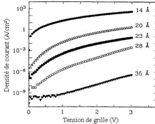
**Figure 5:** Densité de courant de la grille en fonction de la tension de grille pour une capacité CMOS avec différentes épaisseurs d'oxyde de grille SiO<sub>2</sub> [ALM\_03].
