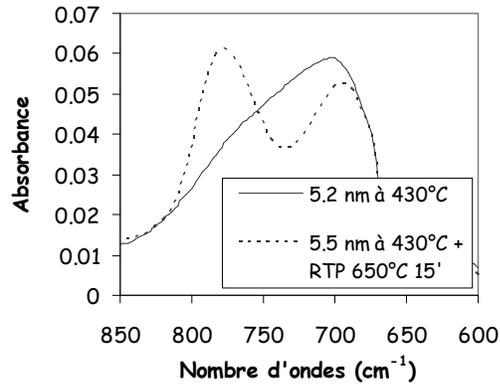
**Figure IV 20:** Spectres ATR de films de HfO<sub>2</sub> avec et sans recuit à 650°C 15' sous N<sub>2</sub>.
