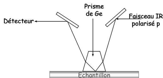
**Figure A.III 1:** Montage en mode ATR
