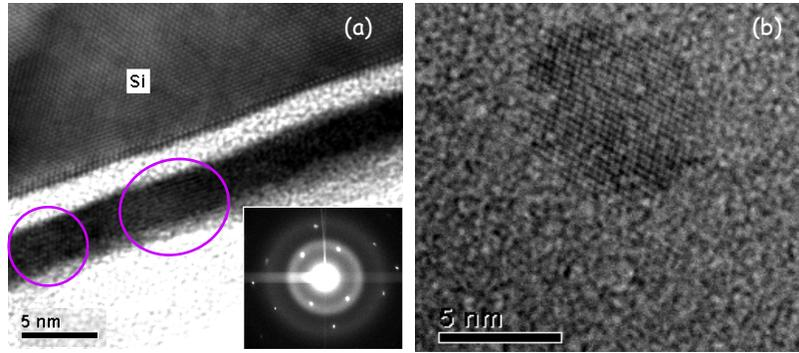
**Figure IV 9:** (a) Figure TEM vue en coupe de 4 nm de l'empilement HfO<sub>2</sub>/SiO<sub>2</sub>/Si déposé à 430°C. L'insert en bas à droite représente la figure de diffraction de cet échantillon. Les anneaux de diffraction correspondent au matériau HfO<sub>2</sub> et les spots observés sont identifiés comme la diffraction du réseau cristallin du substrat de silicium. (b) Figure TEM vue de dessus, dans la structure amorphe, un grain d'environ 5 nm de diamètre est identifié.
