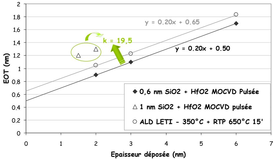
**Figure II 28:** EOT en fonction de l'épaisseur physique du HfO<sub>2</sub> déposé par la technique MOCVD en phase liquide pulsée à une température de 550°C. Les résultats ALD (dépôt CVD en couche atomique) après le dépôt à 350°C et le recuit RTP (Rapid Thermal Annealing) à 650°C durant 15 minutes, sont mis en comparaison.
