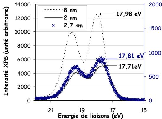
**Figure II 18:** Spectres XPS de la raie Hf 4f des films de HfO<sub>2</sub> d'épaisseurs 2, 2,7 et 8 nm déposés à 550°C.
