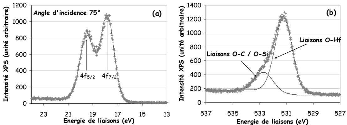
**Figure II 11:** Spectres de niveau de cœur de l'hafnium, Hf 4f (figure (a)), et de l'oxygène O 1s (figure (b)) mesuré par AR-XPS, pour un angle d'incidence de 75°, pour un film de 2,7 nm de HfO<sub>2</sub> déposé à 550°C.
