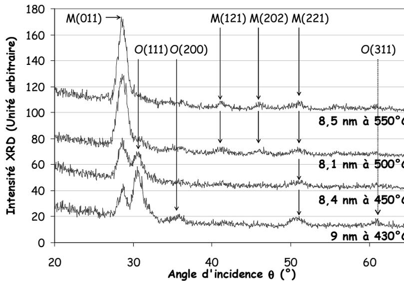
**Figure V 4:** Spectres XRD de films de HfO<sub>2</sub> déposés à différentes températures.
