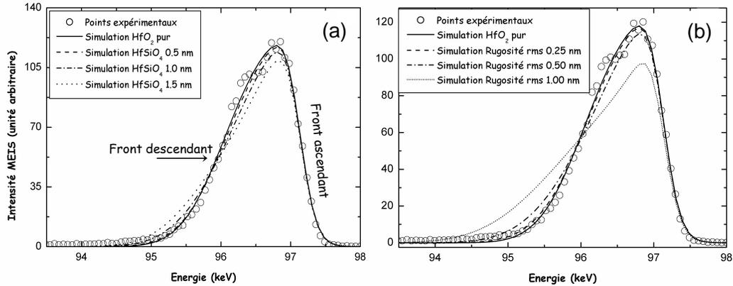
**Figure II 15:** Spectres MEIS des atomes d'hafnium pour le film de HfO<sub>2</sub> déposé à 550°C. Les cercles correspondent aux spectres expérimentaux. La figure (a) correspond aux spectres simulés avec 0,5 nm (tirets), 1 nm (tirets et points) et 1,5 nm de silicate (points). La figure (b) correspond aux spectres simulés avec 0,25 nm (tirets), 0,5 nm (tirets et points) et 1 nm (points) de rugosité à l'interface HfO<sub>2</sub>/SiO<sub>2</sub>.
