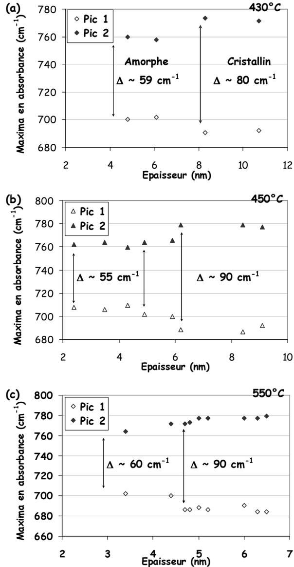
**Figure V 2:** Maxima des pics d'absorption, issue des analyses ATR, en fonction de l'épaisseur de HfO<sub>2</sub> déposé à différentes températures. (a) Pour une température de dépôt de 430°C, (b) de 450°C et (c) de 550°C.
