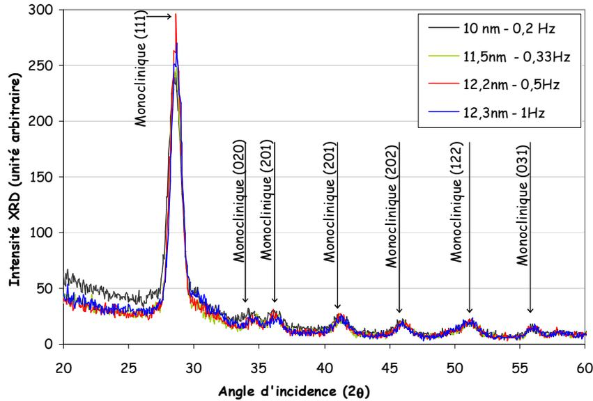
**Figure II 4:** Diagrammes de diffraction X des films ayant une épaisseur de 10 nm de HfO<sub>2</sub>, déposé à 550°C à différentes fréquences. Les positions des pics de diffraction des spectres indiquent que le matériau se trouve dans la phase monoclinique du HfO<sub>2</sub>.
