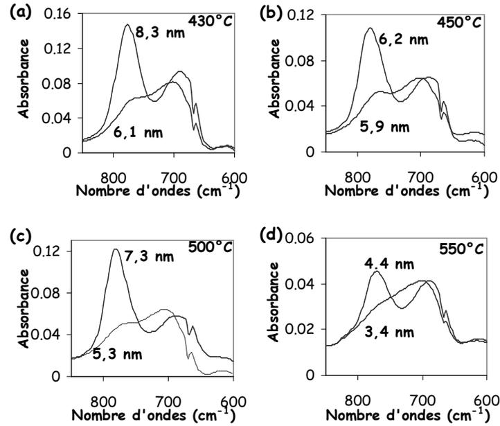
**Figure V 1:** Spectres ATR des films de HfO<sub>2</sub> déposés à 430°C (a), 450°C (b), 500°C (c) et 550°C (d)
