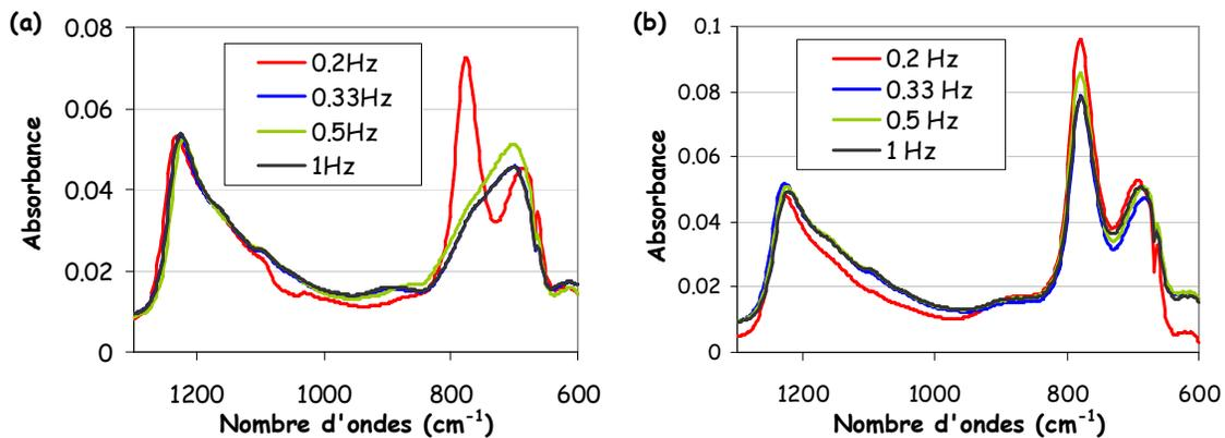
**Figure II 3:** Spectres ATR des films de HfO<sub>2</sub> déposés à 550°C à différentes fréquences d'injection, (a) mesuré sur une couche de 5 nm de HfO<sub>2</sub> (b) et pour un film de 6 nm de HfO<sub>2</sub>.
