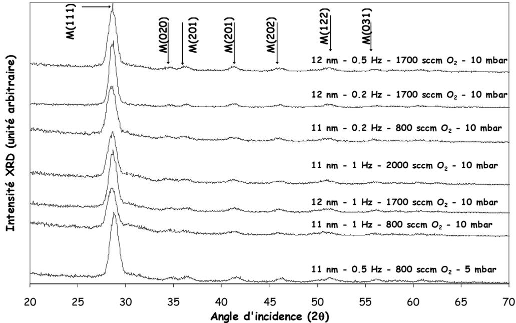
**Figure II 8:** Diagrammes XRD de films de HfO<sub>2</sub> déposés selon différentes conditions de pression, fréquence d'injection et flux d'oxygène. La phase monoclinique du HfO<sub>2</sub> est identifiée.
