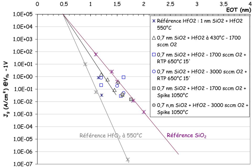
**Figure IV 21:** Figure de mérite de la densité de courant de fuite,  $J_g$ , en fonction de l'EOT pour des films déposés à 430°C sous un flux de 1700 sccm et de 3000 sccm d'oxygène. Les résultats du HfO<sub>2</sub> élaborés à 550°C et du SiO<sub>2</sub> sont mis en référence
