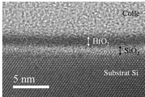
**Figure IV 5:** Image TEM vue en coupe de l'empilement Si/SiO<sub>2</sub>/HfO<sub>2</sub>.
