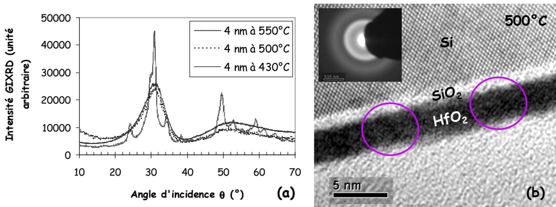
**Figure V 3:** (a) Spectre GIXRD obtenu à l'ESRF (ligne ID01) pour des films de 4 nm de HfO<sub>2</sub> en fonction de la température. (b) Image TEM, vue en coupe, de 4 nm de HfO<sub>2</sub> déposé à 500°C. L'insert en haut à gauche représente la figure de diffraction de cet échantillon.
