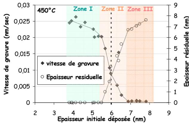
**Figure V 7:** Vitesse de gravure et épaisseur résiduelle de HfO<sub>2</sub> en fonction de l'épaisseur déposée à une température de 450°C.
