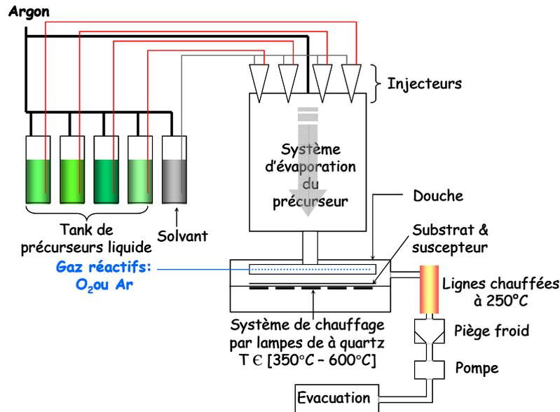
**Figure I 10:** Schéma de fonctionnement de l'équipement.
