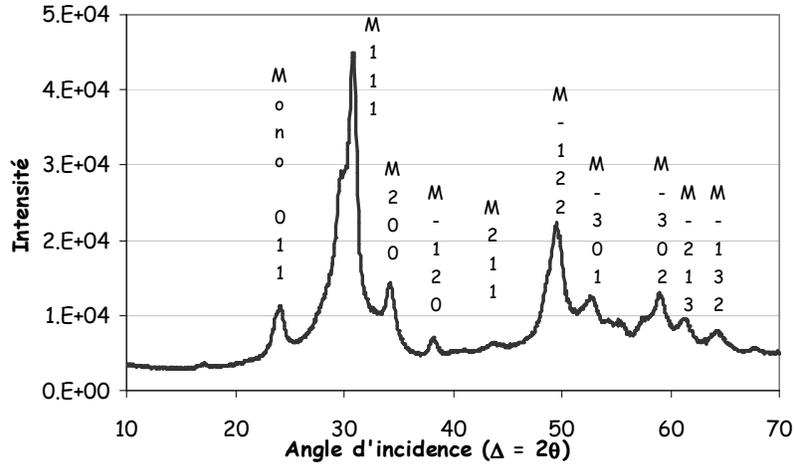
**Figure II 7:** Spectre GIXRD utilisant le rayonnement synchrotron (ESRF – ligne ID 01) obtenue pour 4 nm de HfO<sub>2</sub> déposé à 550°C. Dans tous les cas, la phase monoclinique du HfO<sub>2</sub> est identifiée.
