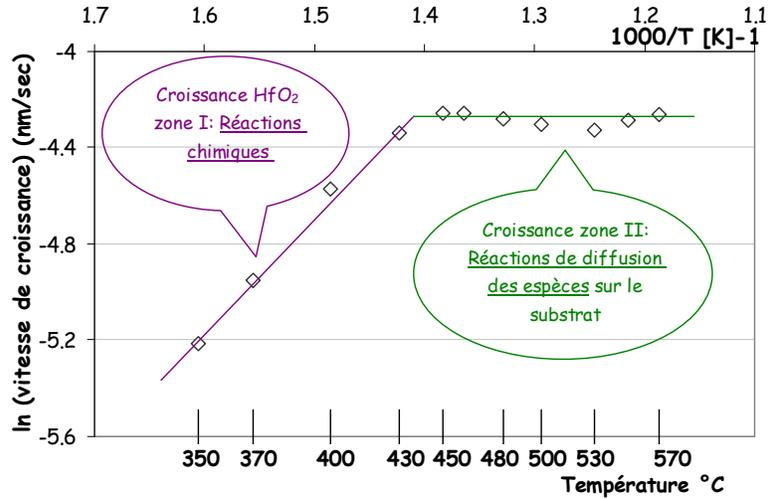
**Figure II 1:** Schéma d'Arrhénius du HfO<sub>2</sub> déposé par MOCVD à injection liquide pulsée.
