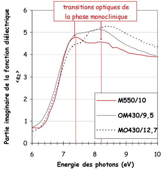
**Figure IV 16:** Partie imaginaire  $\epsilon_2$  de la fonction diélectrique en fonction de l'énergie des photons. L'évolution du mélange des phases orthorhombique et monoclinique vers la phase monoclinique est identifiée.
