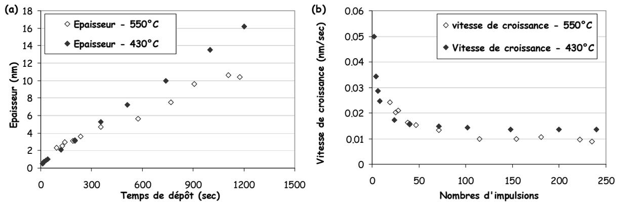
**Figure IV 1** : (a) Épaisseur de HfO<sub>2</sub> en fonction du temps pour des dépôts effectués à 430°C et 550°C. (b) Vitesse de croissance du HfO<sub>2</sub> en fonction du nombre d'impulsions.
