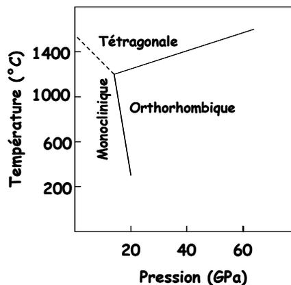
**Figure I 3:** Diagramme de phase (P,T) du  $\text{HfO}_2$  [WAN\_92]
