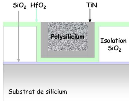
**Figure II 25:** Représentation schématique d'une capacité MOS pour l'intégration du HfO<sub>2</sub>.
