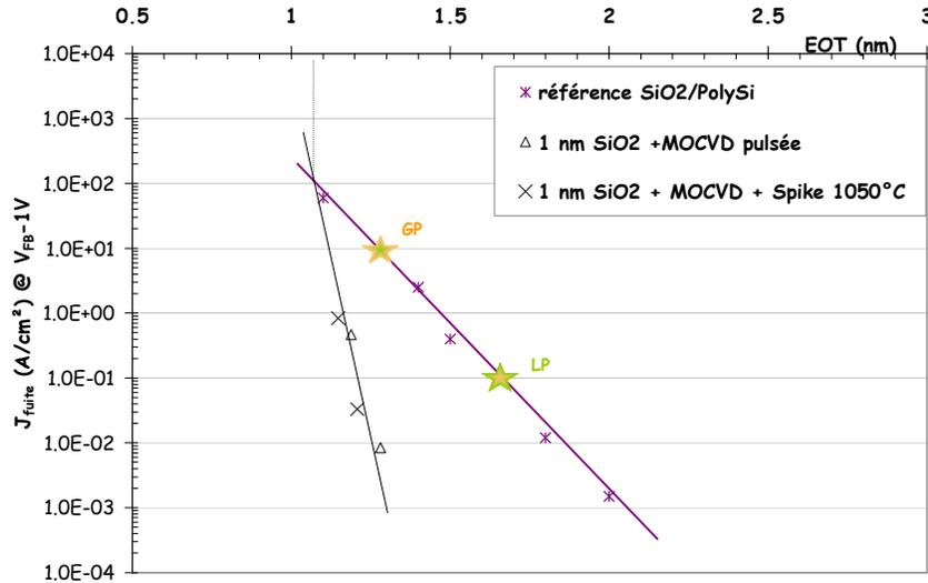
**Figure II 29:** Densité de courants  $J_{fuite}$  en fonction de l'EOT. L'effet du recuit « spike » à 1050°C est comparé avec les films de HfO<sub>2</sub> non recuits. La courbe de performance du SiO<sub>2</sub> est mise comme référence.
