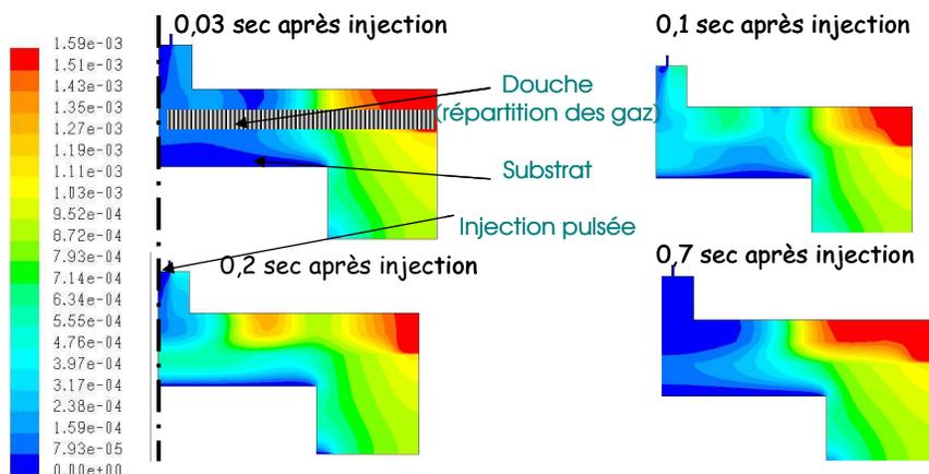
**Figure A.VII 1:** Fraction molaire du produit de première décomposition "  $Hf_d$  " du précurseur, en fonction du temps au cours d'un cycle d'injection de 1s : 0,03 s après l'injection (en haut à gauche) puis 0,1s (en haut à droite) 0,2s et 0,7s après l'injection.
