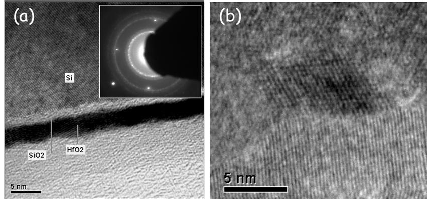
**Figure II 6:** Images TEM de 3,5 nm de HfO<sub>2</sub> déposé à 550°C sur un substrat SiO<sub>2</sub>/Si. (a) Vue en coupe. L'insert à gauche montre la figure de diffraction de la couche. Les spots de diffraction du silicium sont aussi détectés. Il s'agit des spots caractéristiques du substrat. (b) Vue de dessus. La présence de grains est clairement identifiée.
