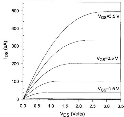
**Figure 9:** Caractéristiques  $I(V)$  pour un film de  $\text{TiO}_2$  de 19 nm d'épaisseur, dans une structure capacité MIS (Métal Isolant Semi-conducteur), de type p. La capacité dépend de la polarisation de la grille (platine). L'analyse, qui tient compte d'une forte épaisseur de l'interface  $\text{SiO}_2$ , indique que la constante diélectrique totale de l'empilement est de 30. [CAM\_97].
