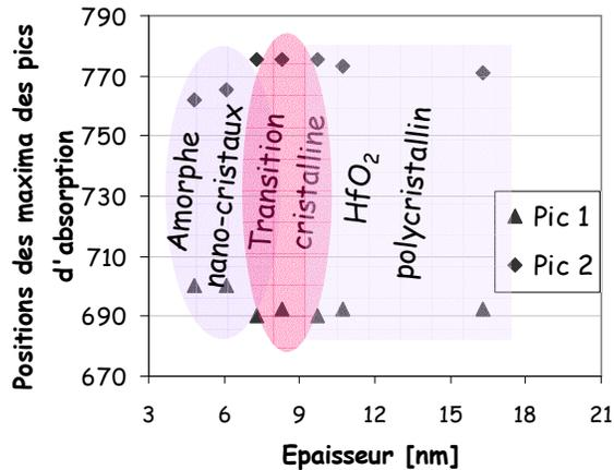
**Figure IV 11:** Résultats de simulations des spectres ATR. Les maxima des bandes d'absorption sont tracés en fonction de l'épaisseur de HfO<sub>2</sub>.
