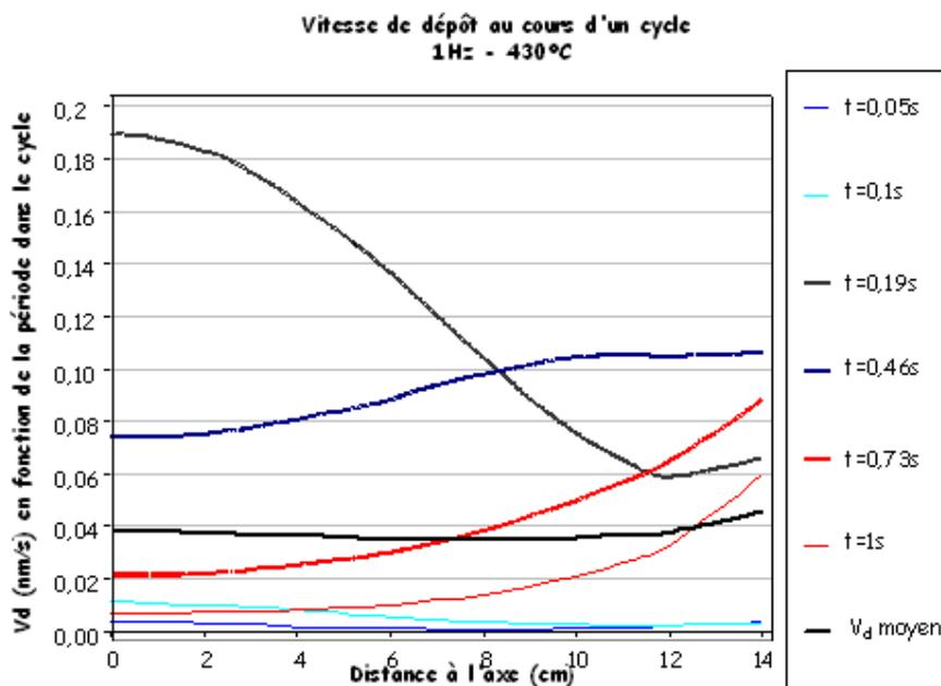
**Figure A.VII 2 :** Vitesse du dépôt en fonction de la distance à l'axe. La vitesse moyenne de dépôt du HfO<sub>2</sub> (courbe noire pleine) et les contributions à cette vitesse de dépôt en fonction du temps au cours d'un cycle sont représentées
