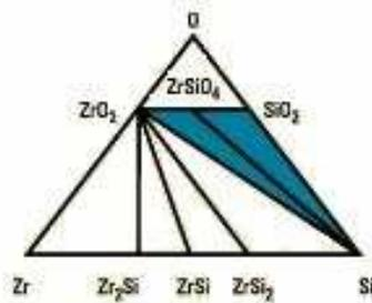
**Figure 10:** Diagramme de phase ternaire du zirconium et de l'oxygène en contact avec le silicium des composés oxydes, silicate et siliciure créés avec l'élément Zr. Les lignes entre les composés sont représentatives de composés stables en contact entre eux à une température égale ou inférieure à  $900^\circ\text{C}$  et en dessous (issue de la publication de Wallace [WAL\_01']).
