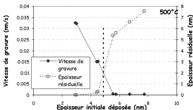
Figure A.XII 4: Vitesse de gravure et épaisseur résiduelle en fonction de l'épaisseur de HfO<sub>2</sub> déposée à 500°C.
