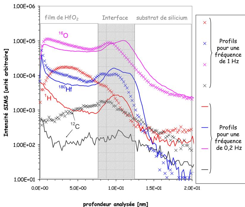
**Figure III 2 :** Profils SIMS de films de 10 nm de HfO<sub>2</sub> déposés à 430°C. L'analyse compare l'effet d'une fréquence d'injection de 1 Hz à celle de 0,2 Hz, principalement sur les profils du carbone et de l'hydrogène
