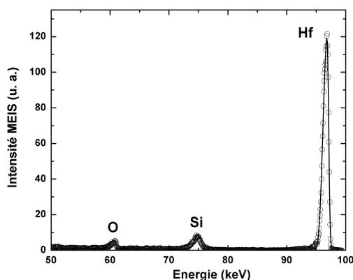
**Figure A.IX 1:** Spectre MEIS expérimental de l'empilement HfO<sub>2</sub>/SiO<sub>2</sub>/Si(100) déposé à 430°C.
