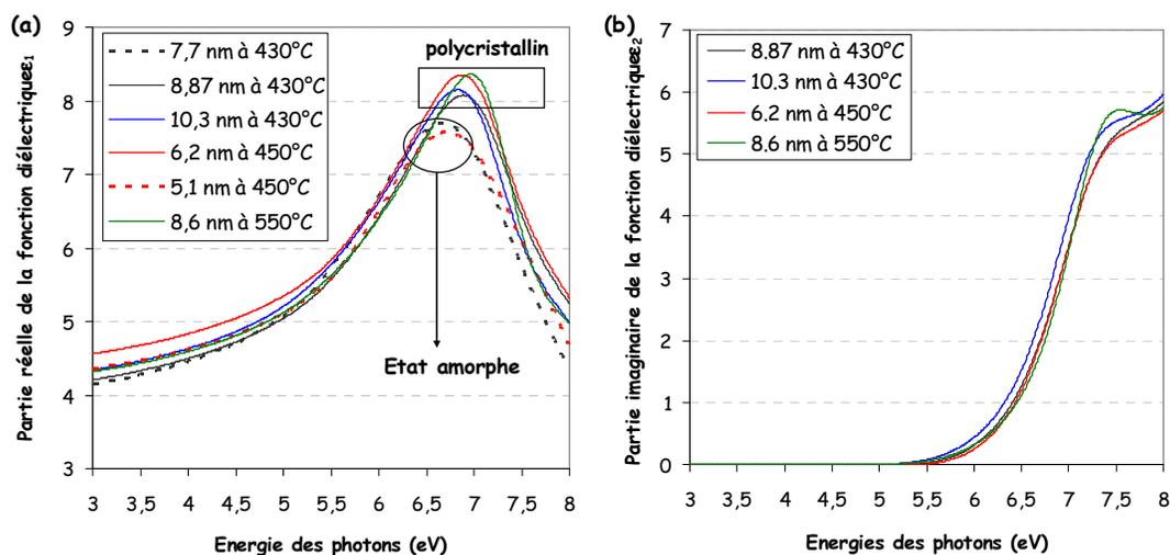
**Figure A.XI 1:** (a) Partie réelle et (b) partie imaginaire de la fonction diélectrique du HfO<sub>2</sub> obtenue pour des films élaborés à 430°C et 450°C.
