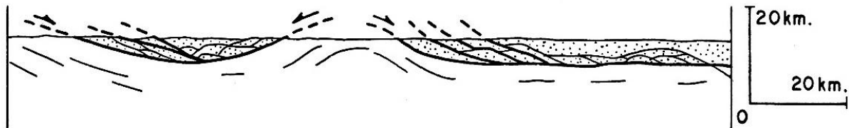
Figure I.2.10 : Coupe interprétative au sein d'une croûte archéenne illustrant le modèle d'extension post-orogénique (Yilgarn craton, Australia). Les roches supracrustales ainsi que les ceintures de roches vertes sont représentées en pointillées et les roches gneissiques et granitiques en blanc. D'après Choukroune et al., 1997 et références incluses.
