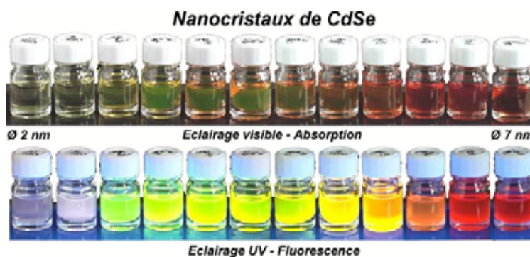
Figure II-21 Dépendance des propriétés optiques (absorption en haut et fluorescence en bas) de la taille des nanocristaux à l'exemple de nanocristaux cœur de CdSe entre 2 et 7 nm
