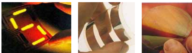
Figure II-13 Dispositifs électroniques ou optoélectroniques à base de polymères conjugués : diodes électroluminescentes, cellules photovoltaïques et transistors à effet de champ (de gauche à droite).
