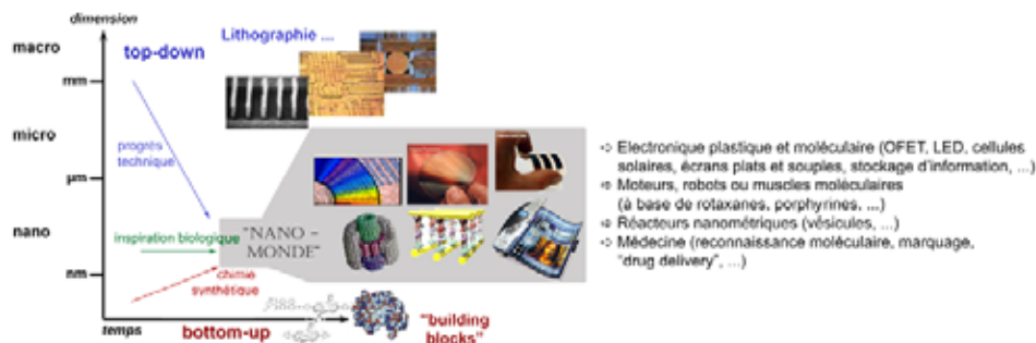
Figure II-1 On peut approcher le domaine nanométrique « par le haut » (top-down), en réduisant les dimensions, ou « par le bas » (bottom-up), en assemblant des briques de base moléculaires, afin d'obtenir des dispositifs complexes et petits. Une forte interaction entre la chimie synthétique et la compréhension physique est indispensable. Souvent la biologie est utilisée comme modèle, notamment au niveau dimensionnel.
