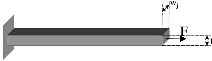
Fig. 41 ) Barreau de silicium avec contrainte en traction
