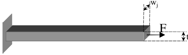
Fig. 41 ) Barreau de silicium avec contrainte en traction
