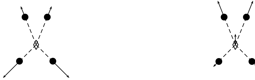
FIG. 7.17: Comportement schématique de la sphère de coordination de l'ion paramagnétique dans \text{Al}_2\text{O}_3 . On a projeté dans un plan contenant l'axe C_3 (vertical) quatre des oxygènes de la sphère de coordination. L'ion paramagnétique est au centre. On a représenté par des flèches le sens des déplacements. Les longueurs relatives des flèches donnent une indication de l'intensité du déplacement. Bien entendu, cette figure n'est absolument pas à l'échelle, les déplacements étant très petits par rapport à la longueur des liaisons. À gauche, le schéma représente le comportement du chrome et du titane. À droite, le schéma représente le comportement du fer.
