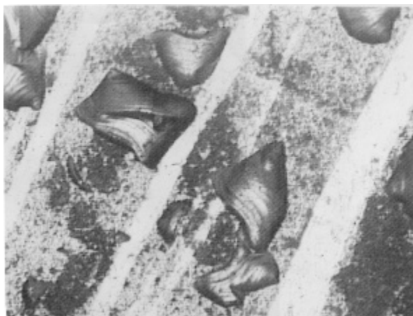
Figure 38. Traces de coups sur un fragment de vitrail archéologique observées au microscope optique (500×).
