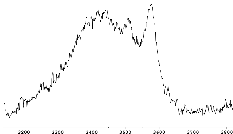
Spectre(s) Raman {31} de la zone des très hauts nombres d'ondes : bandes des groupements OH de la molécule d'H 2 O probablement adsorbée sur l'échantillon étalon de ZnO -CAZN09-
