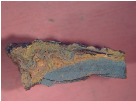
Photo G4 : détail d'une coupe de la corrosion du lingot en fer (L1) ; grossissement : 2,5×
