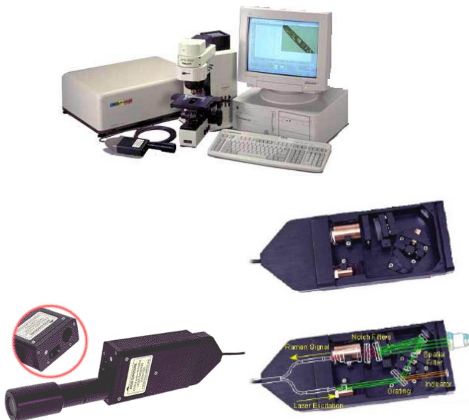
Figure 9. Photographie de la microsonde KAISER HoloLab Series 5000 ® ainsi que le détail des fibres optiques et objectifs utilisés ; KAISER Optical © .
