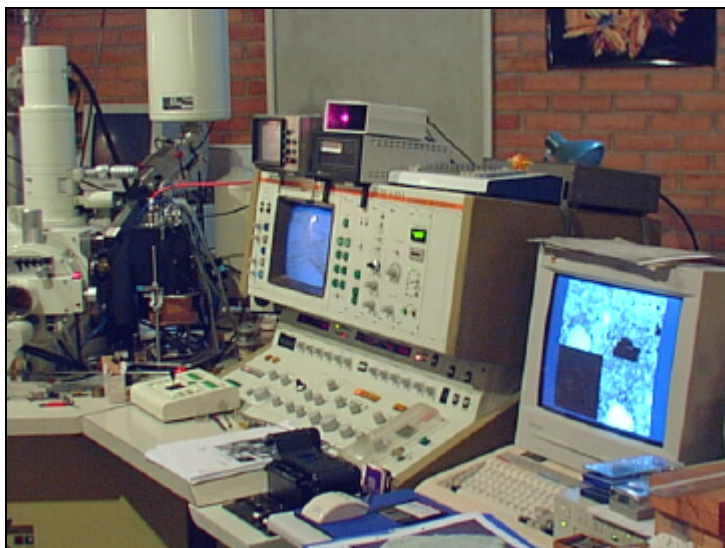
Figure 12. Photographie de l'appareillage utilisé lors des analyses par MEB/EDX ; (JSM-840A).
