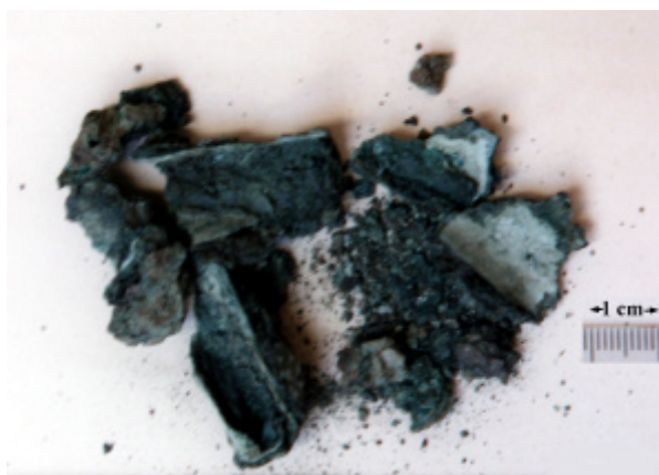
Photo L84-85 : fourreau en bronze à l'état pulvérulent ; attaque par les chlorures de cuivre (atacamite/clinoatacamite).
