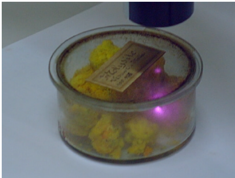
Photo F22 : photographie d'un échantillon de molysite sous verre (à l'abri de l'oxygène de l'air) grâce à une sonde Raman Kaiser HoloLab équipée de fibres optiques.
