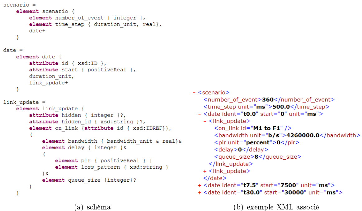
FIG. 4.16: Extrait d'un scénario d'émulation pour la partie scénario
