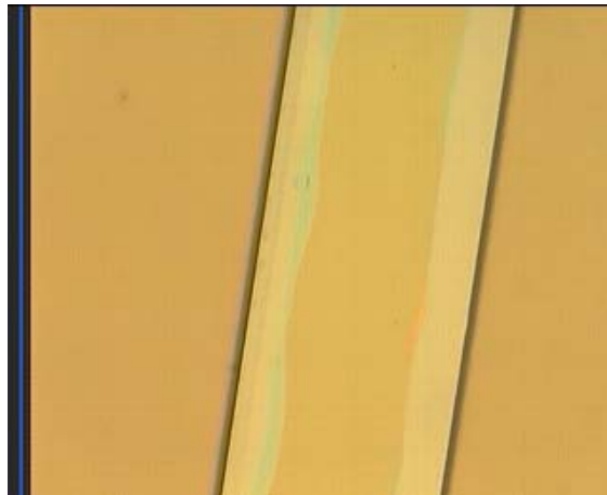
Figure 2-3 : Photographie au microscope optique du front d'oxydation lors de nos premiers résultats.
