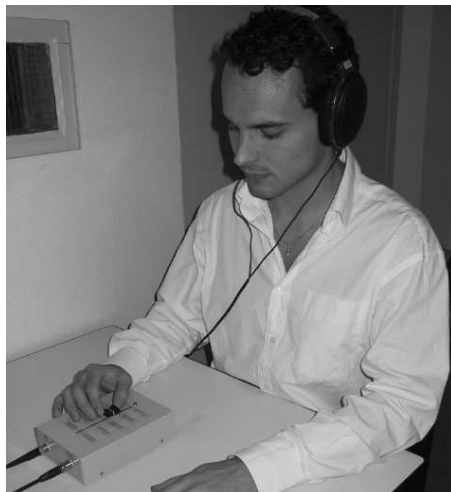
FIG. 4.6 – Auditeur évaluant le désagrément d'une séquence sonore jouée au casque au moyen du boîtier muni du curseur coulissant le long de l'échelle graduée.
