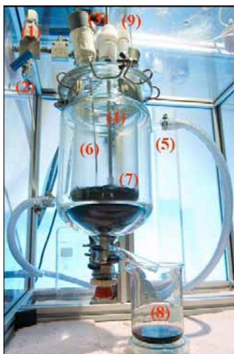
Figure II.3. Photographie du module de fonctionnalisation des nanoparticules : (1) : disque de rupture, (2) : vanne de purge, (3) : vanne régulatrice, (4) : tige de la pale d'agitation, (5) : enceinte thermostatée, (6) : tuyau de sortie des nanoparticules, (7) : solution colloïdale, (8) : récupération de la solution, (9) : sortie des vapeurs et des gaz.
