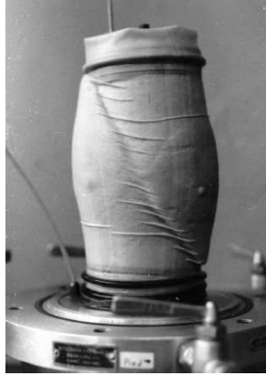
Figure 1.1: Bande de cisaillement dans un sable lors d'un essai triaxial, [Colliat-Dangus, 1986] d'après [Desrues et Chambon, 2002]
