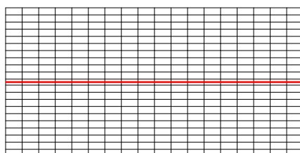
Figure 4.8: Lignes de discontinuité pour le maillage b
