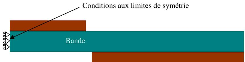
**Figure 2.3 :** Conditions aux limites de type symétrie pour le découpage 2D.
