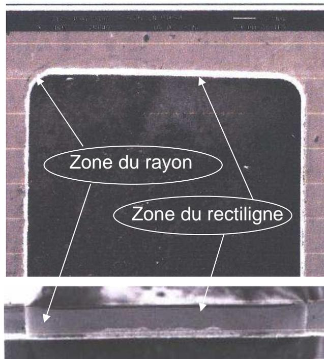
**Figure 5.9 :** Photographies du profil de découpe pour une empreinte rectangulaire [95].
