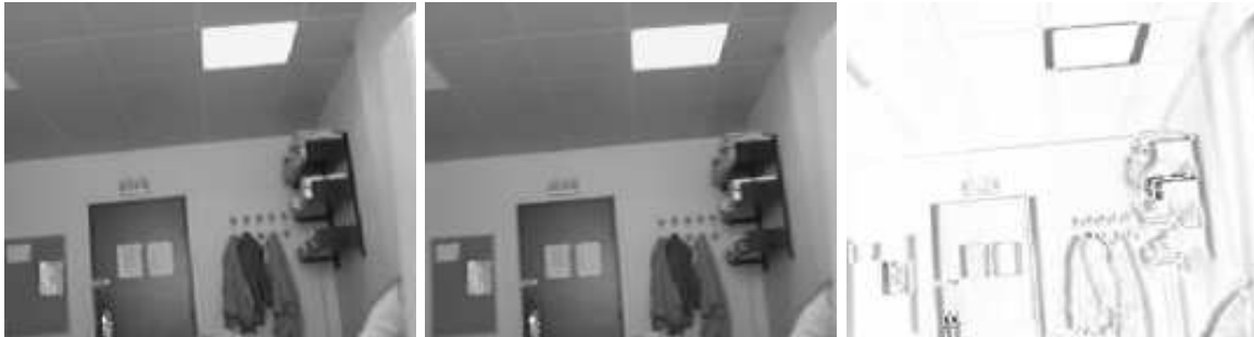
FIGURE 3: Deux images consécutives issues d'une séquence réelle et l'image des différences entre les deux (plus le niveau de gris est foncé, plus la différence est importante). Deux problèmes sont examinés : l'estimation du mouvement de la caméra à partir d'un couple d'images consécutives, puis l'estimation de la structure de la scène.
