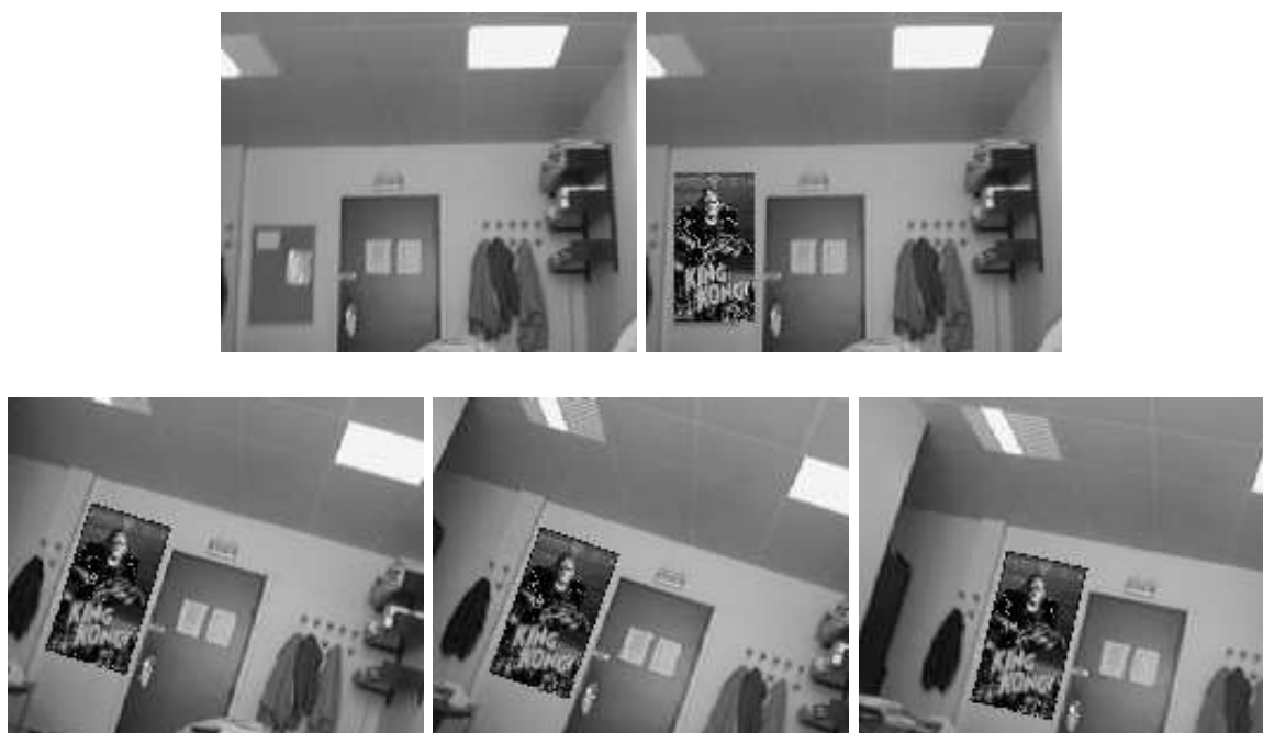
FIGURE 2: Exemple de réalité augmentée. En haut, le tableau d’affichage du bureau est masqué par une affiche de cinéma. Au-dessous, les images 10, 20 et 30 de la séquence obtenue en déformant l’affiche avec le mouvement de la caméra.
