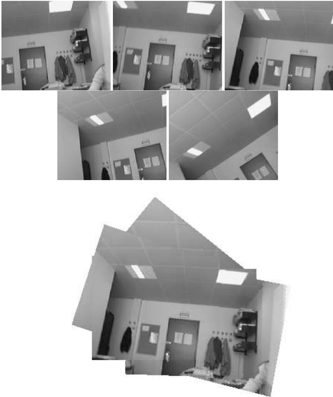
FIGURE 3.10: En haut, les images 10, 30, 60, 70 et 80 de la séquence. En bas, le panorama construit du point de vue de l'image 60.
