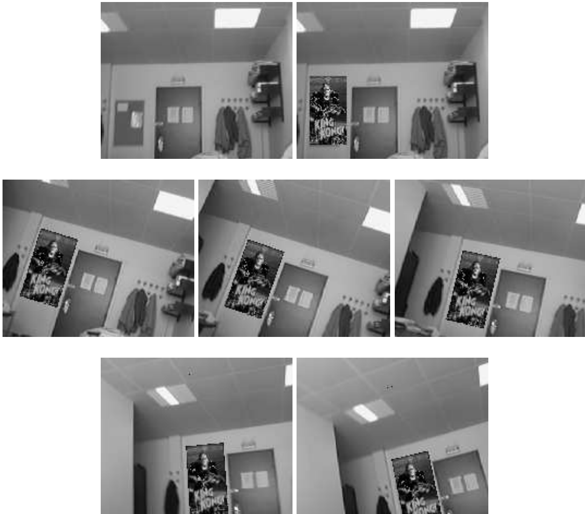
FIGURE 3.8: Disparition du tableau d'affichage au profit d'une affiche de cinéma. En haut : l'insertion de l'affiche sur la première image. Au-dessous, les images 10, 20, 30, 40 et 45 de la nouvelle séquence obtenue en déformant l'affiche avec les estimations des mouvements de la caméra.
