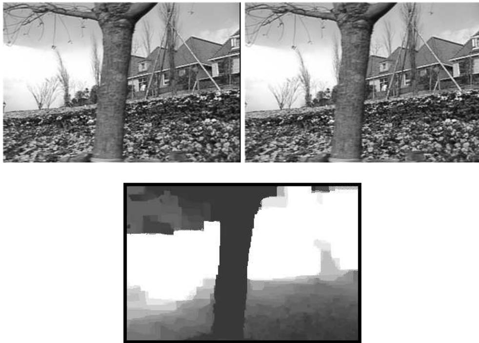
FIGURE 4.13: *En haut, deux images consécutives extraites de la séquence Flower Garden. Puis, l'estimation des profondeurs par la Belief Propagation (100 itérations) en utilisant le mouvement de la caméra entre les deux images estimé par la méthode du chapitre 3.*
