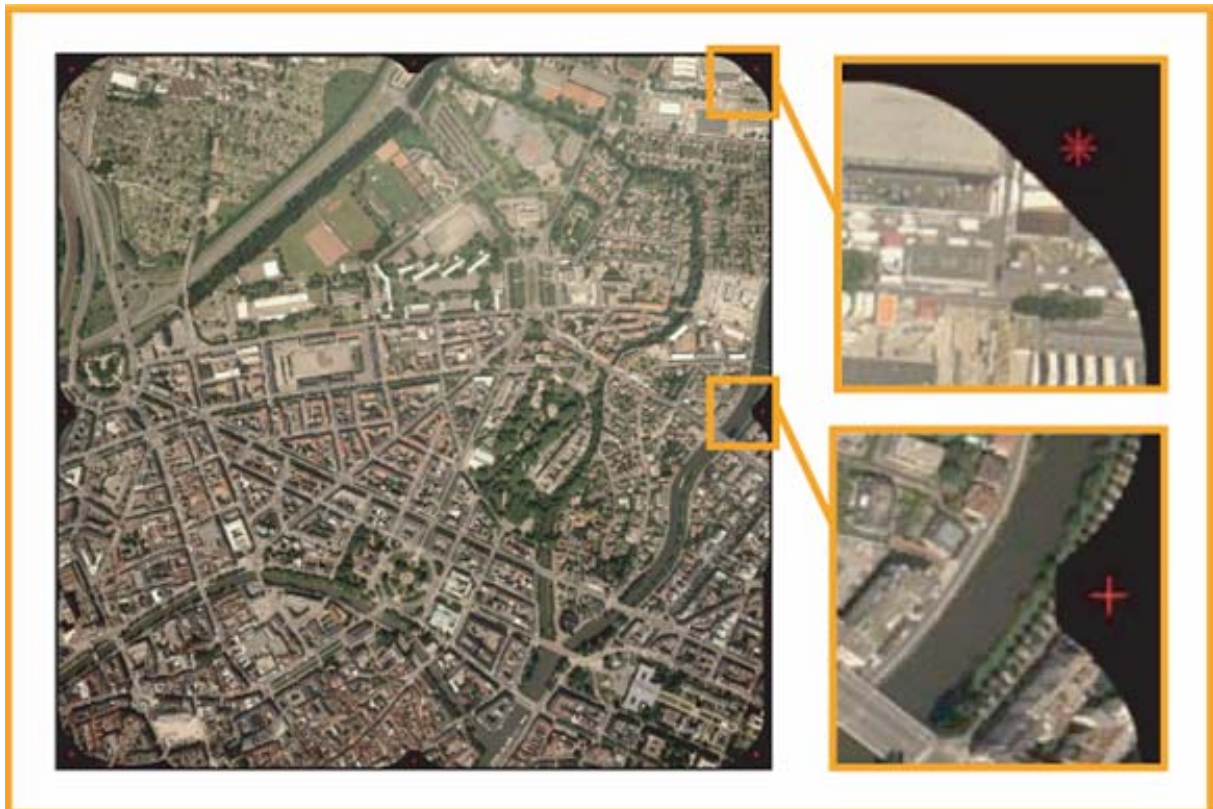
Figure 12 : repères de fond de chambre imprimés sur la photographie lors de la prise de vue
