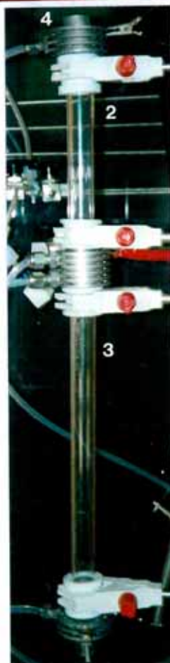
Figure I.10 : Dispositif expérimental : appareillage C.V.D. permettant d'obtenir des dépôt de TiC et de SiC en continu sur substrat filamentaire.
