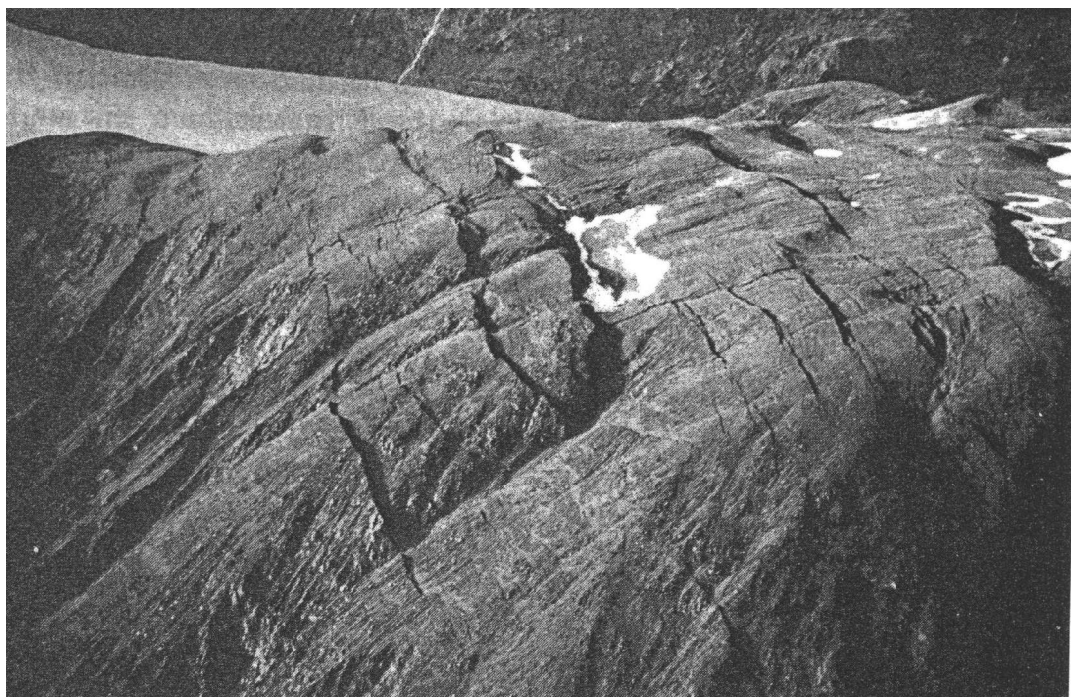
Figure 18 : Contres pentcs en Alaska (Radbruch-Hall, 1978). La hauteur maximale des escarpements observés est de 3,80m.
