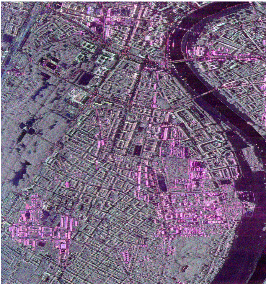
FIG. IV.9 – Image polarimétrique du site de Dresde (base de PAULI : hh + vv , hh - vv , hv )
